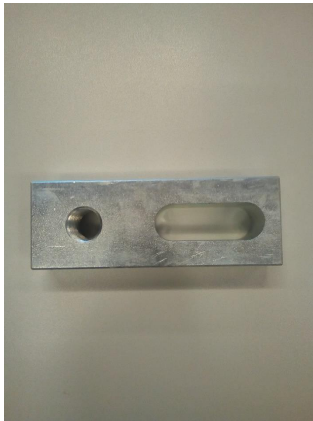
Slika 46: Uzorak za ispitivanje ultrazvučnom metodom (Izradio autor)
