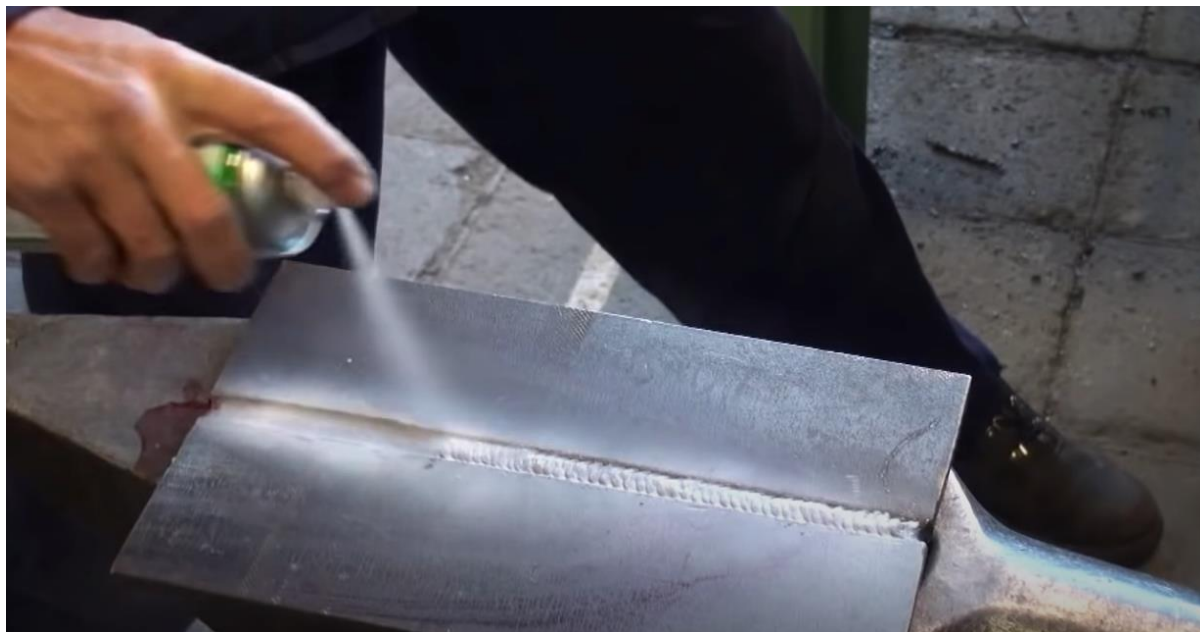
Slika 32: Primjer nanošenja razvijača [28]
