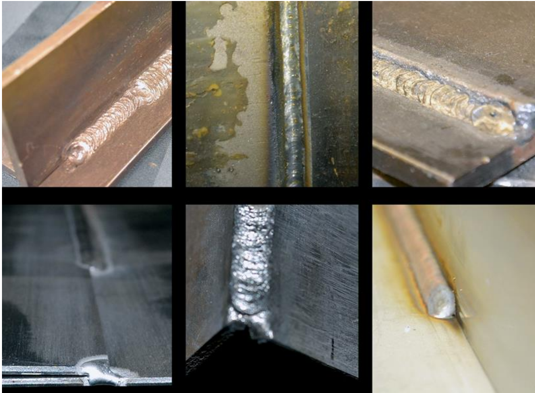
Slika 4: Primjeri kutnih zavara [4]
