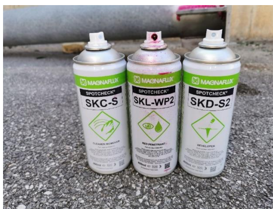
Slika 29: Sredstva za provedbu ispitivanja (čistač, penetrant i razvijatelj, s lijeva na desno) (Izradio
