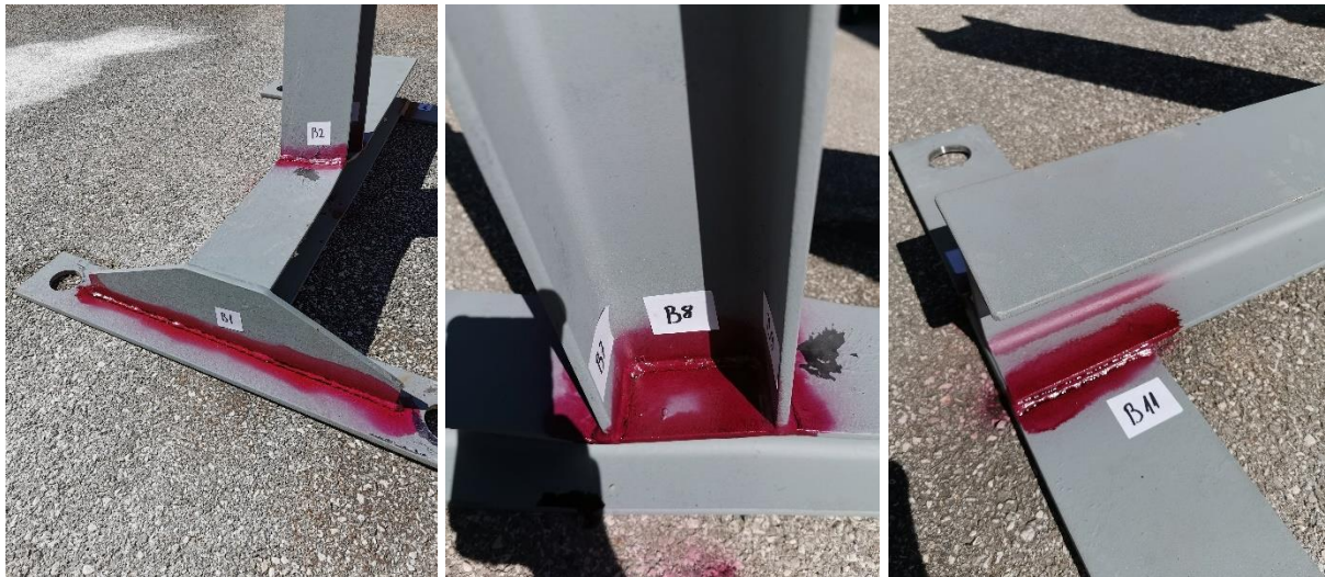
Slika 36: Uzorak B s nanesenim penetrantom (Izradio autor)
