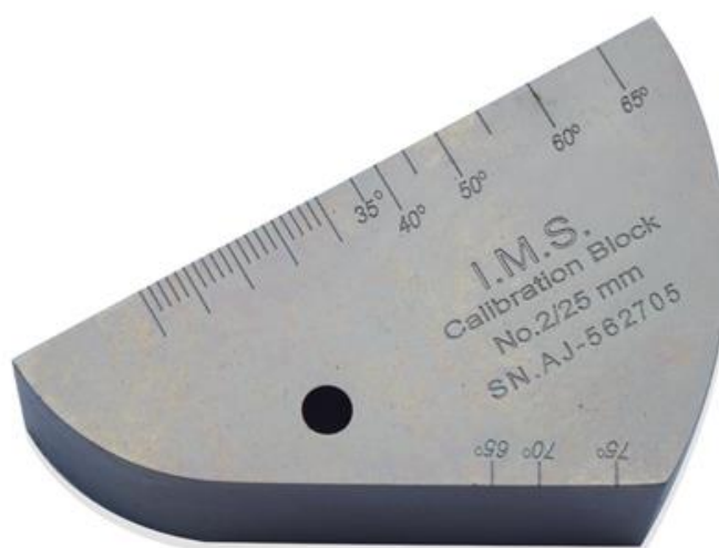
Slika 52: Kalibracijski blok prema ISO 7963 [23]
