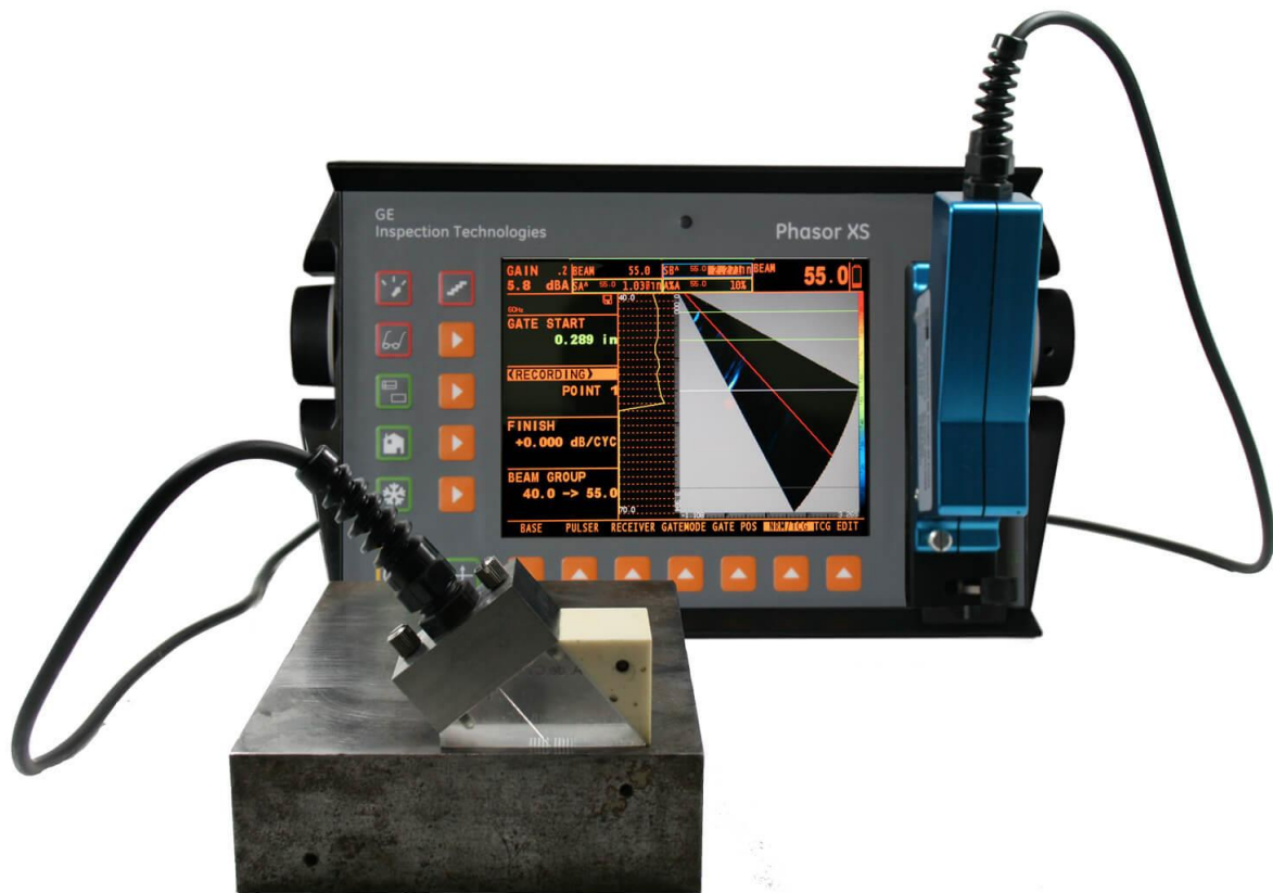
Slika 17: Ultrazvučni uređaj Phasor XS [17]
