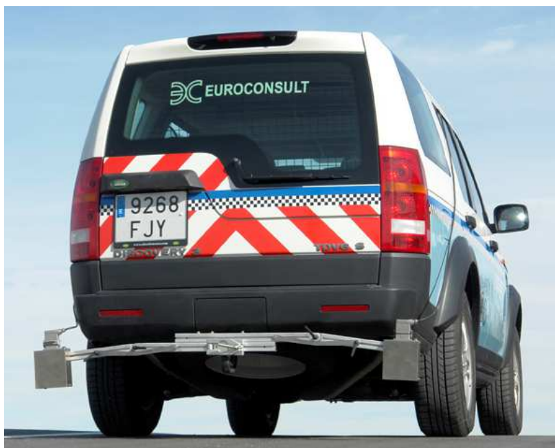
Slika 27. Montirani LaserProof na kuku za vuču osobnog vozila [27]
