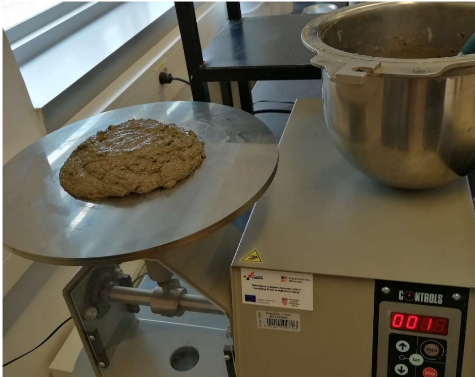
Slika 8. Izgled mješavine nakon rasprostiranja
