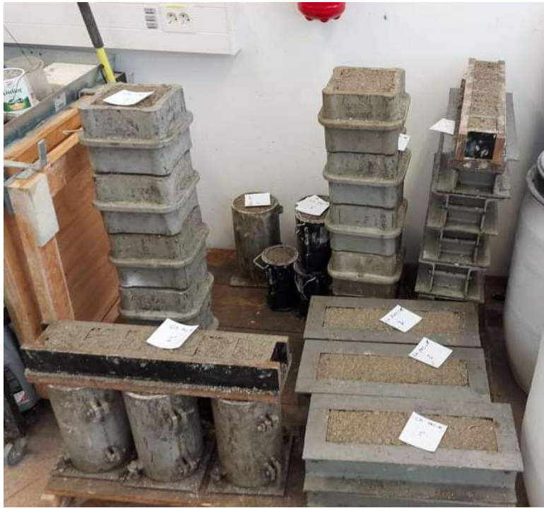
Slika 31. Ugrađeni kalupi na sušenju
