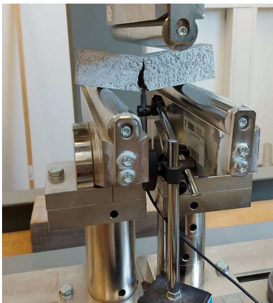
Slika 16. Uzorak u uređaju za testiranje metodom kontrole pomaka te LVDT ispod
