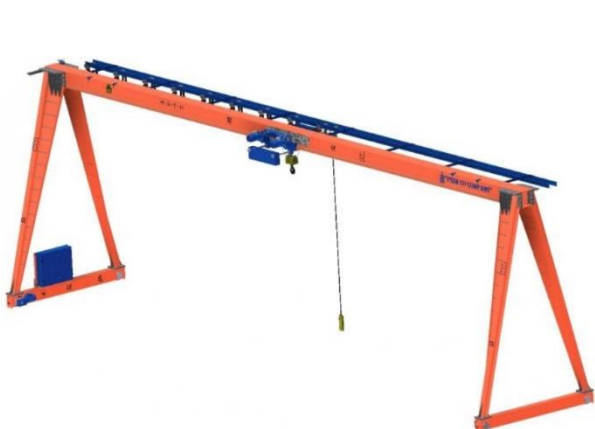
Slika 7: Jednogredni portalni kran
