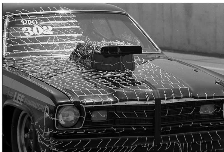
Slika 44: Strujanje fluida oko automobila (površinska „tuft“ metoda) [9]
