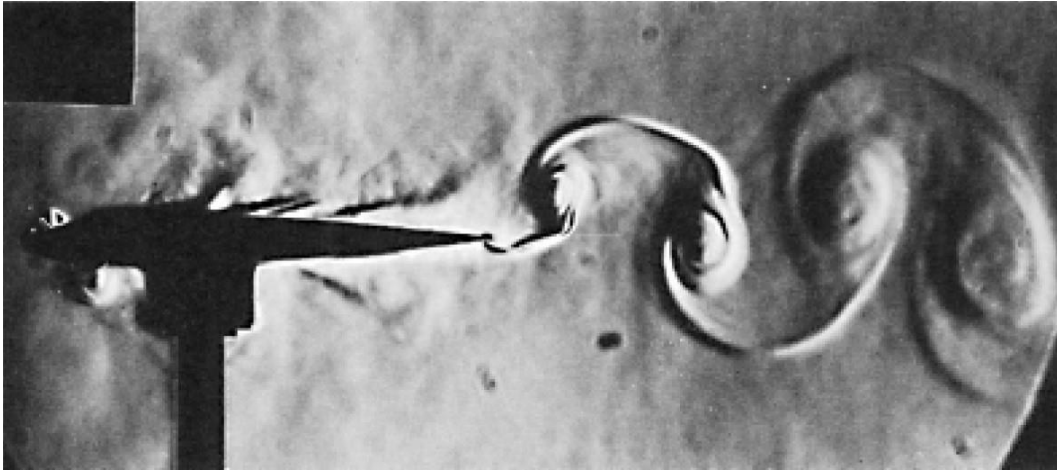
Slika 49: Strujanje fluida na dnu mrtve točke vertikalno vibrirajućeg krila (Schlierenova metoda) u zraku, brzina strujanja 5 m/s, duljina akorda 100 mm, Re = 3 \cdot 10^4 , vibracijska frekvencija 90 Hz, jednostruka amplituda 4 mm [3]
