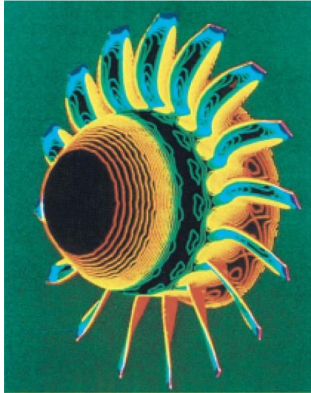
Slika 53: Raspodjela gustoće na rotirajućim lopaticama ventilatora i centrifuge, vanjski promjer 450 mm, brzina rotacije 12 700 o/min (plava boja: niska rotacija, crvena boja: visoka rotacija), (metoda konačnih razlika) [3]
