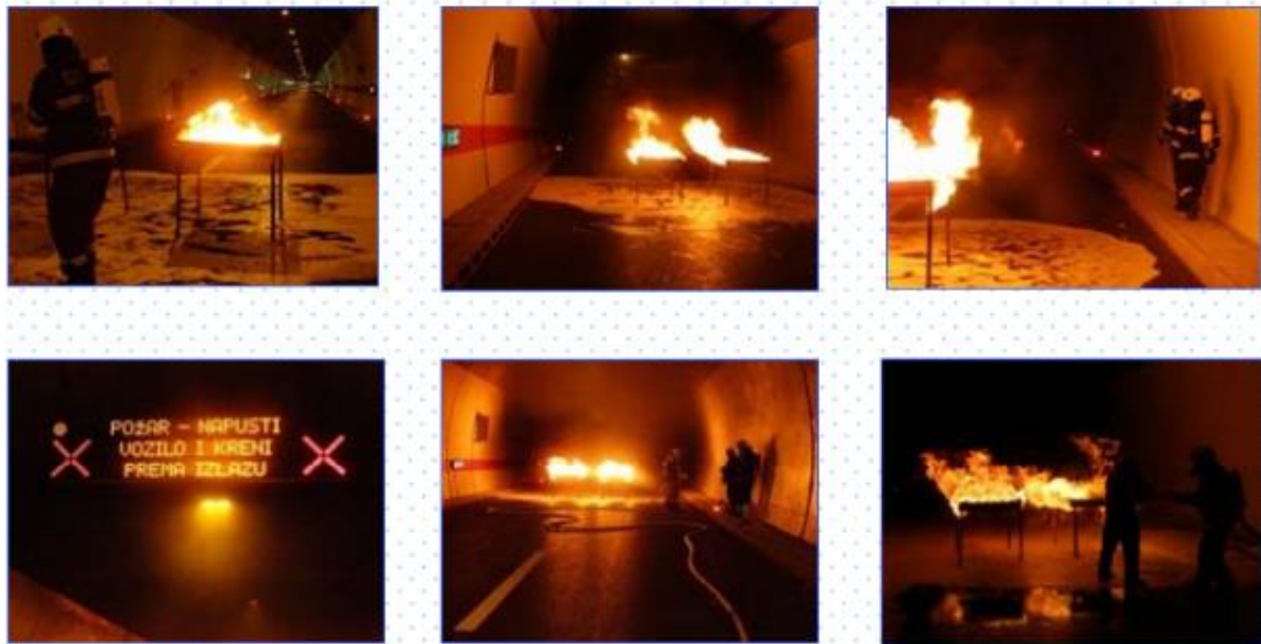
Slika 26: Probno paljenje u tunelu Sveti Rok [27]
