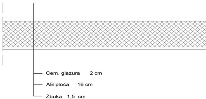
Slika 15: Slojevi ploče pozicije 100
