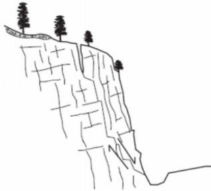
Slika 23: Pokos stijenske mase s izraženim diskontinuitetima [45]
