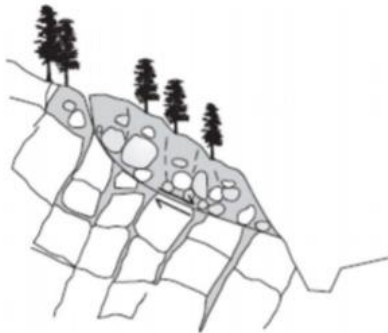
Slika 24: Slom u trošnoj stijenskoj masi [45]
