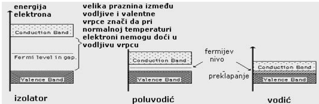
Slika 3.3 Vodljiva i valentna vrpca kod izolatora, poluvodiča i vodiča
