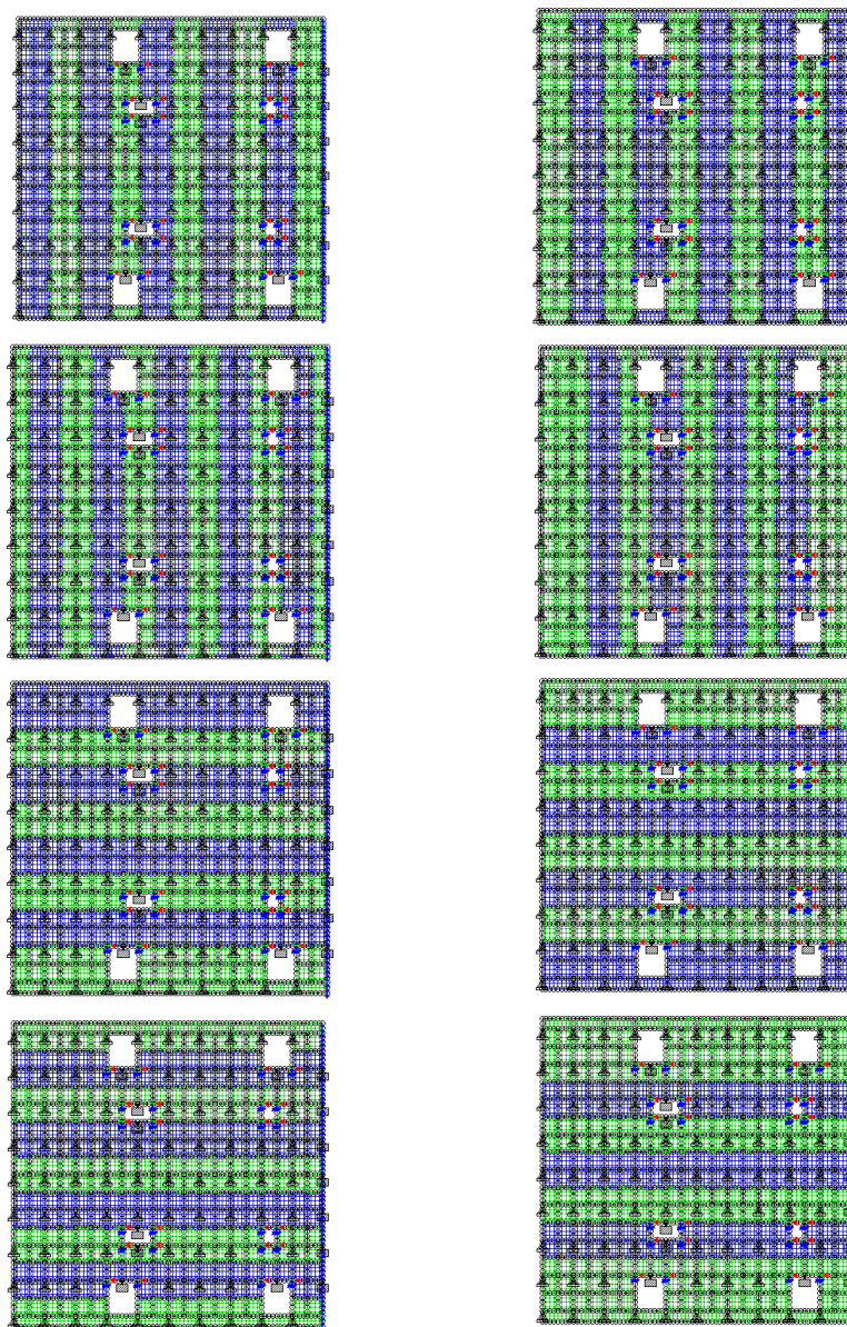
Slika 11. Sheme promjenjivog opterećenja na stropnoj konstrukciji (plava boja označava opterećeno polje, a zelena boja neopterećeno polje)
