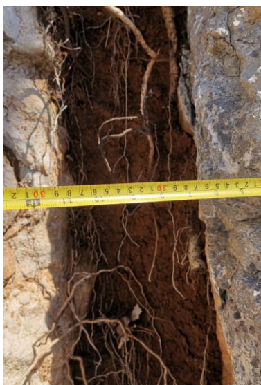
Slika 19. Detalji ispune i hrapavosti diskontinuiteta (Fotografija: Filip Marfan).
