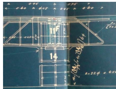
Slika 40: Prikaz armature u stupu S202 [ 7 ]
