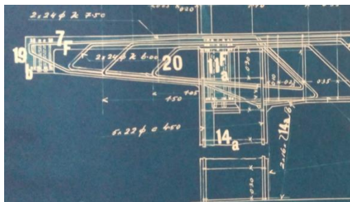
Slika 39: Prikaz armature u stupu S201 [ 7 ]
