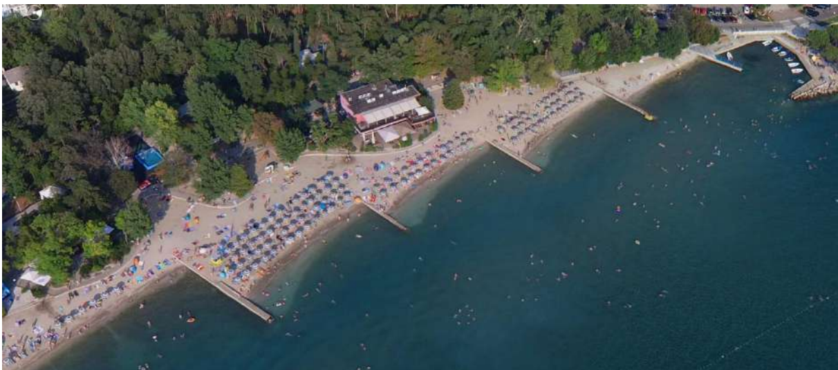
Slika 18. Gradsko kupalište Crikvenica . prikaz pera, načina zadržavanja sedimenta i visine istih ( https://okolo.com/o/91d2e434-acf5-11e5-9a88-001e67995544#y96p41z30 )
