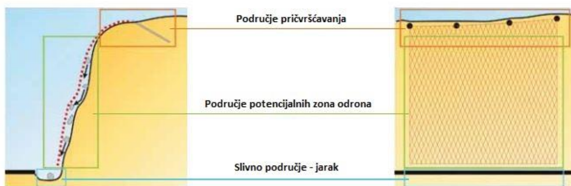
Slika 8: Žičana mreža postavljena po sistemu "zavjese"[9 - modificirano]
