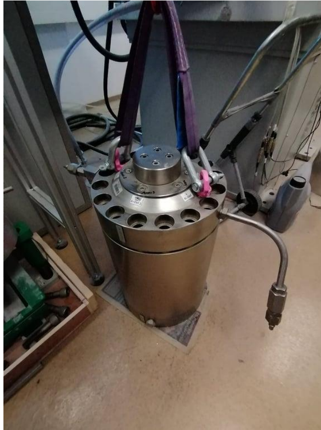
Slika 6: Triaksijalna ćelija u Laboratoriju Građevinskog fakulteta u Rijeci
