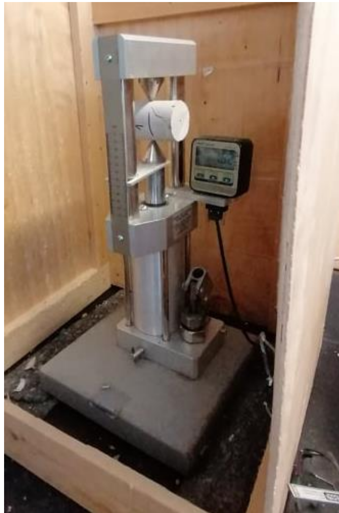
Slika 10: PLT uređaj u Laboratoriju za geotehniku Građevinskog fakulteta u Rijeci
