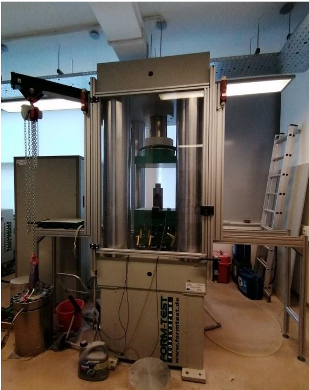
Slika 5: Preša za jednoosno tlačno ispitivanje u Laboratoriju za geotehniku na Građevinskom fakultetu u Rijeci
