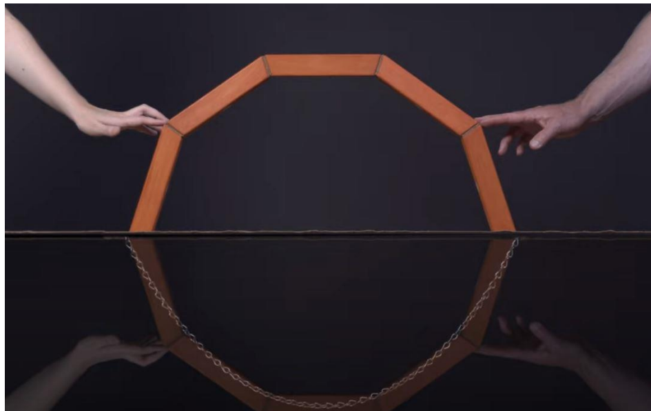
Slika 7. Model luka napravljen od drva i usporedba s lančanicom neposredno prije sloma [7]
