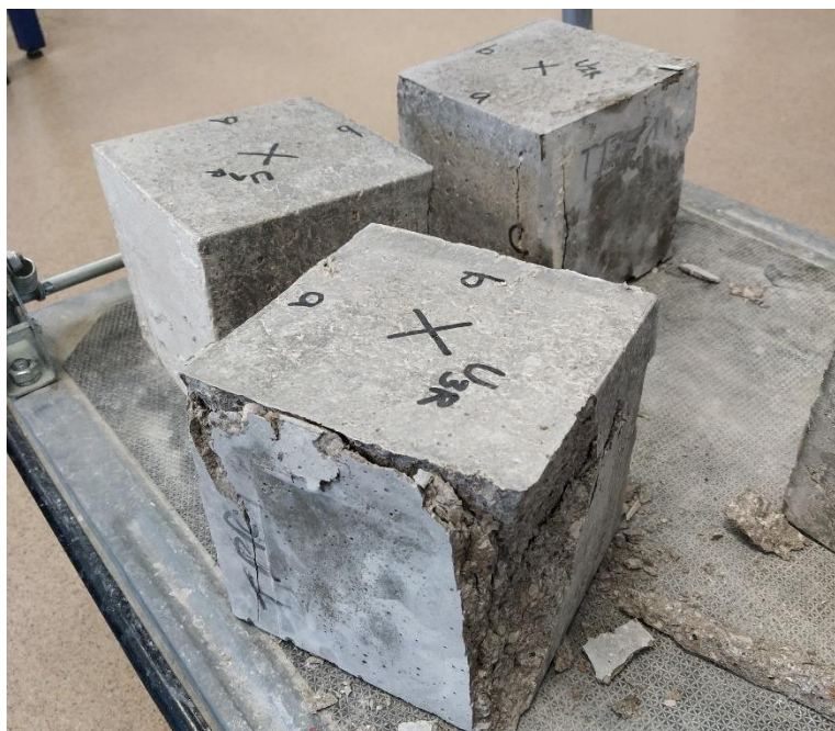
Slika 25 Oblik sloma uzorka pod utjecajem tlačne sile mješavine 1 (REF)
