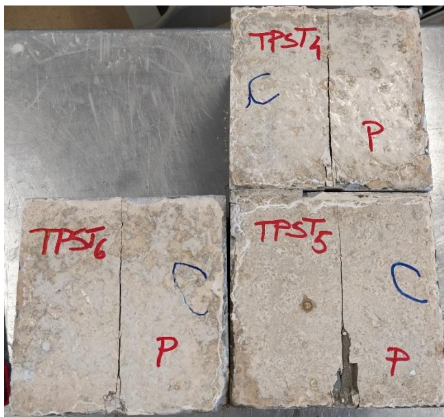
Slika 41 Slom uzoraka prilikom nanošenja vlačne sile cijepanjem mješavine 4
