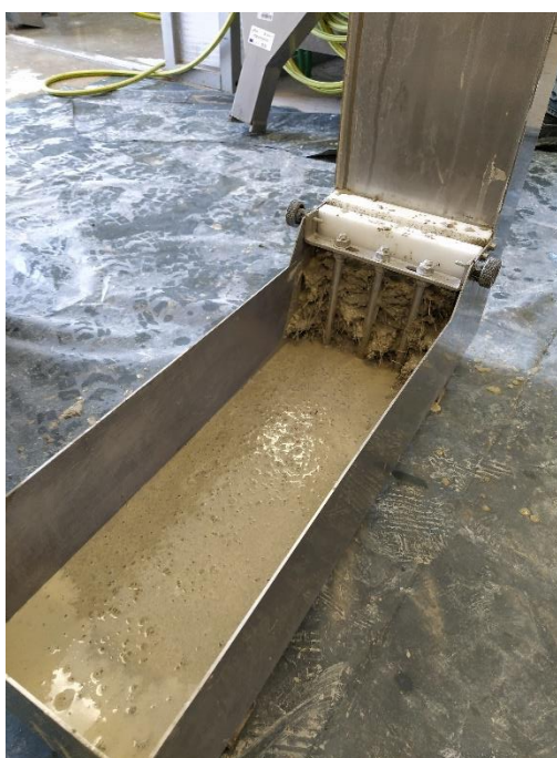
Slika 19 Zaglavljenje vlakana prilikom ispitivanja
