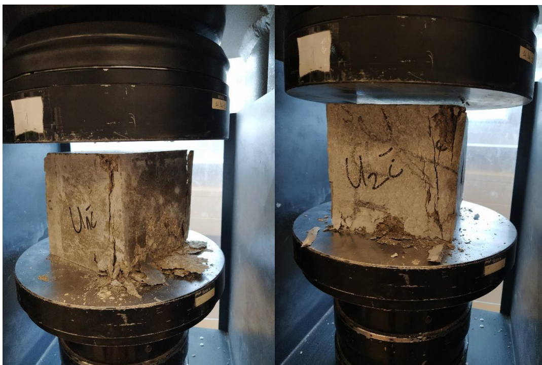
Slika 27 Oblik sloma pod utjecajem tlačne sile na mješavini 2
