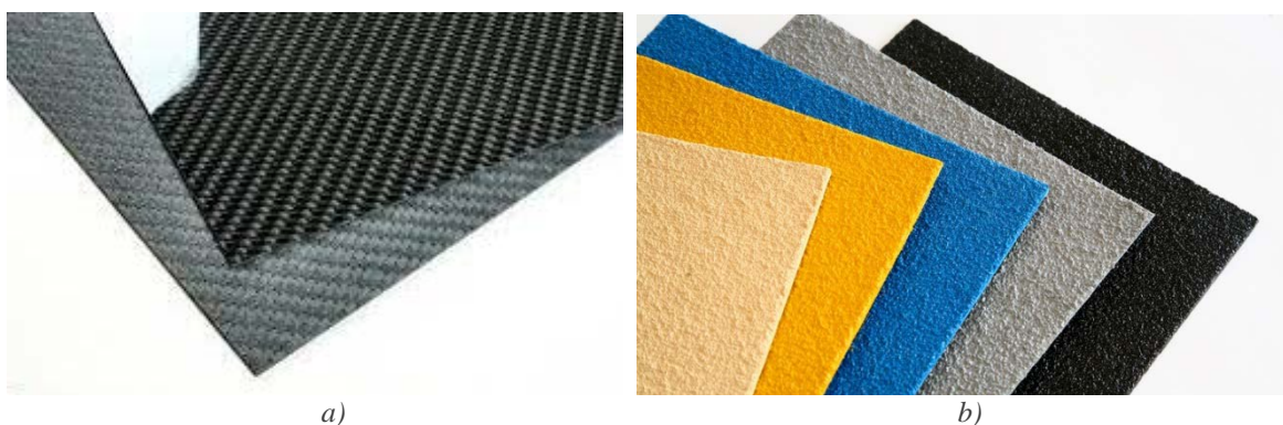
Slika 2.10 Tipovi polimera ojačanih a) karbonskim vlaknima, b) staklenim vlaknima
