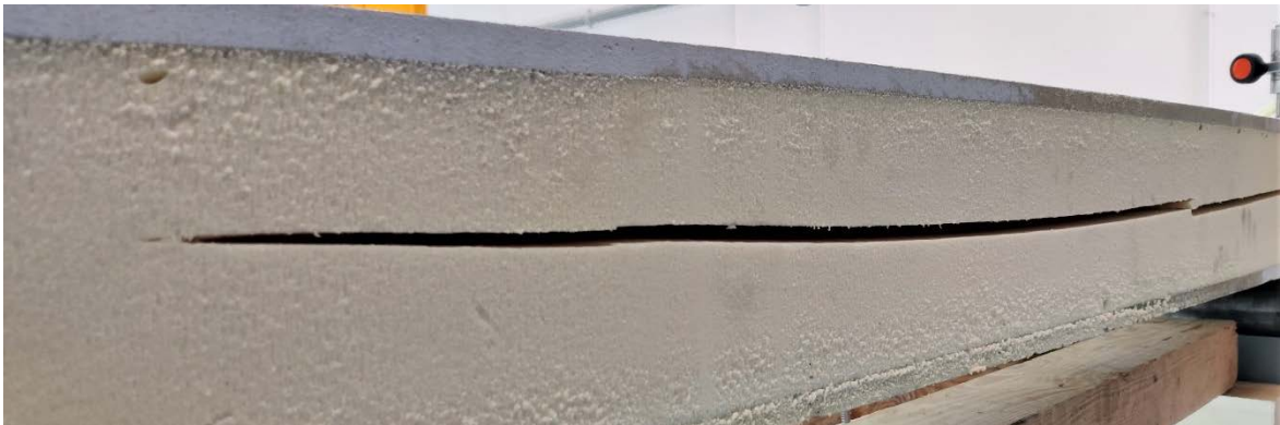
Slika 3.15 Prikaz pukotine na uzorku P3-Fp2-45
