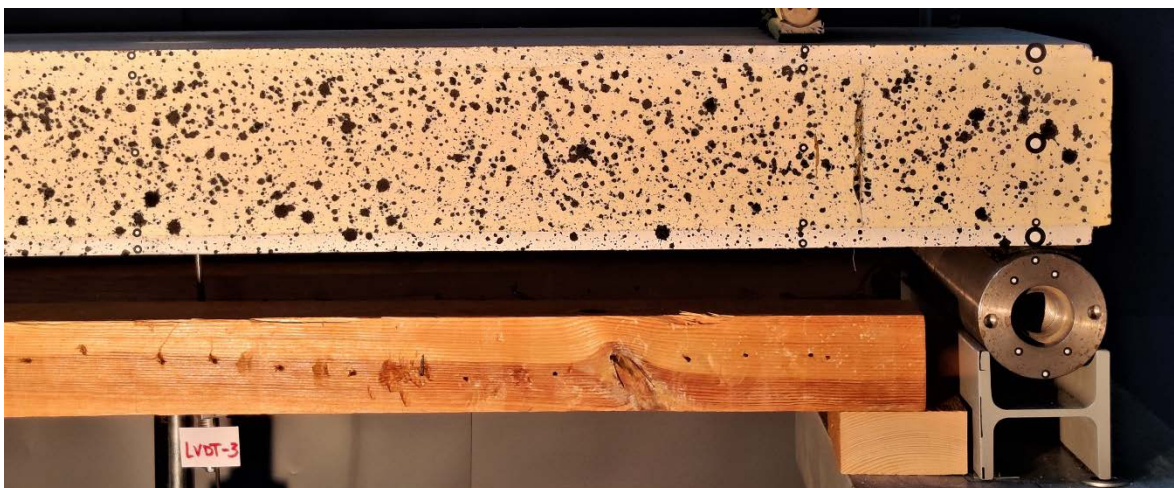
Slika 3.13 Prikaz pozicija crno-bijelih točaka
