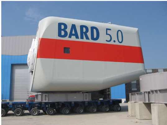
Slika 8 Kompozitni paneli u konstrukciji vjetroelektrane [9]
