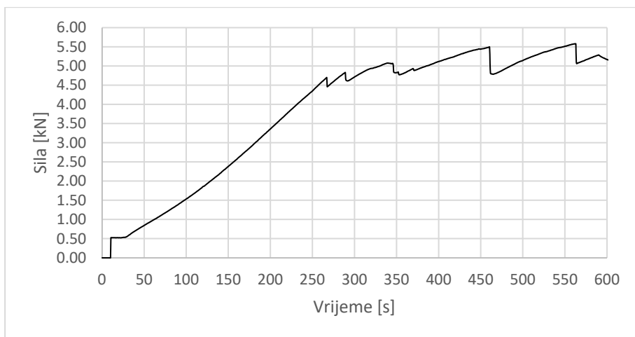
Dijagram 13 – Prikaz djelovanja sile na uzorak u vremenu
