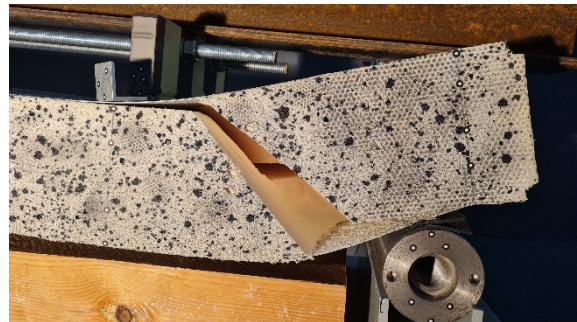
Slika 36 Prikaz sloma uzorka pri ispitivanju PROBA 1/ SP2-45 – detalj (fotografirala Doc. dr. sc. Paulina Krolo)
