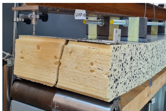
Slika 39 Prikaz sloma uzorka pri ispitivanju PROBA 2/ SP2-45 – pogled bočno (fotografirala Doc. dr. sc. Paulina Krolo)
