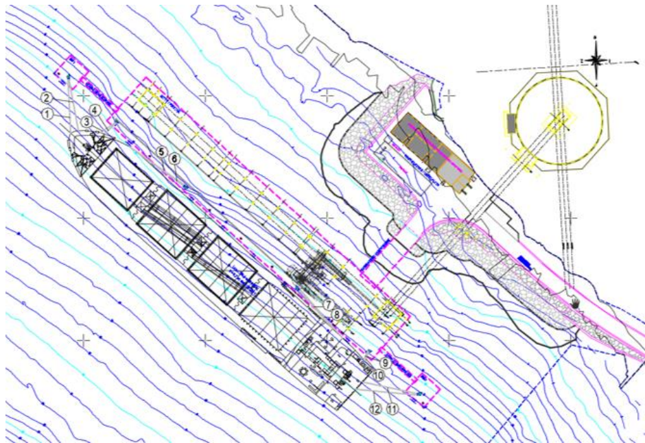
Slika 16: Prikaz broda 25000 dwt na molu s veznim linijama [28]
