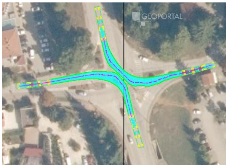
Slika 19. Provoznost - lijevi skretači s glavnog smjera
