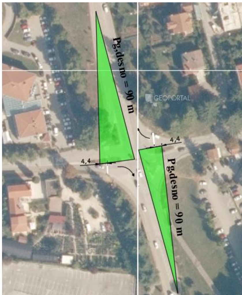
Slika 14. Preglednost desnih skretača sa sporednih pravaca
