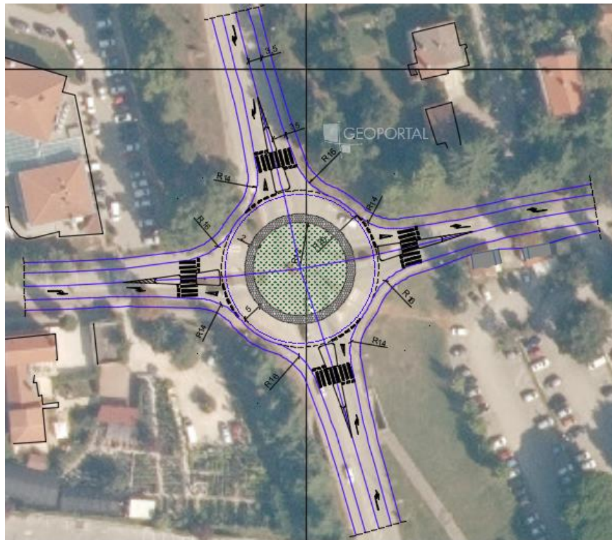
Slika 24. Varijantno rješenje 2 - klasično jednotračno kružno raskrižje
