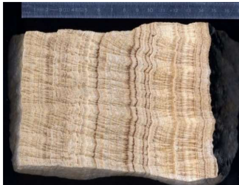
Slika 18: Primjer laminarne strukture na travertinu [20]
