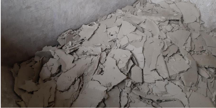
Slika 24.: Obraðeni prešani mulj, PKV Butoniga, (Foto: Tamara Mošnja, 2021.)
