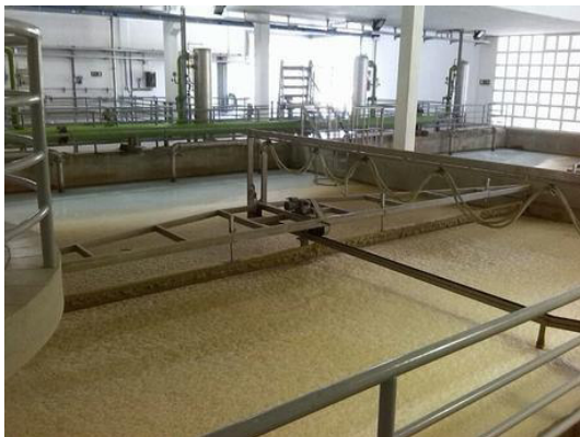
Slika 14.: Koagulacija, flokulacija i flotacija, PKV Butoniga [12]
