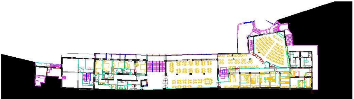
Slika 54: Tlocrt etaže suterena s1 hotela Jadran (izvor: idejni projekt "Studia Remik" d.o.o.)
