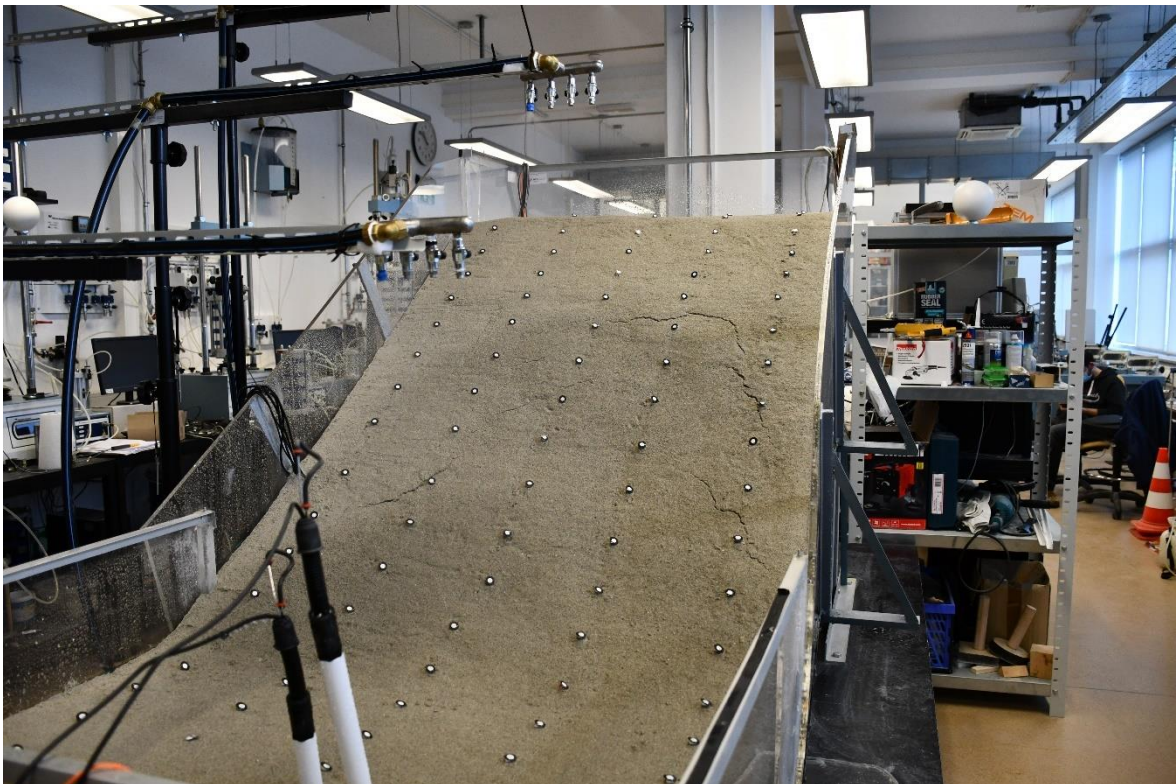
Slika 44: Prikaz nastanka nekoliko pukotina u pokusu 2
