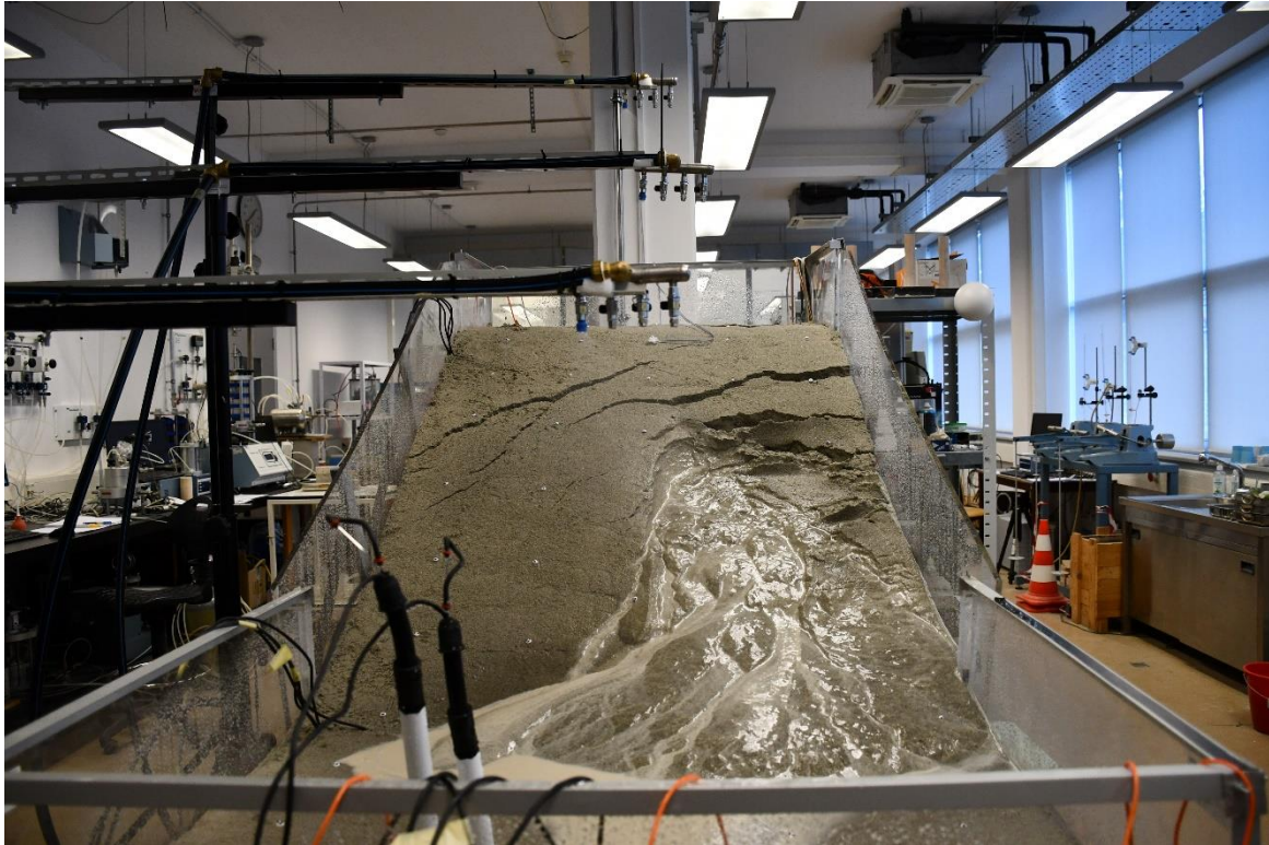
Slika 31: Prikaz kretanja kliznog tijela u pokusu 1
