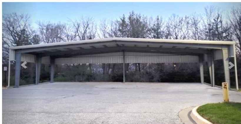
Slika 9: Primjer nadstrešnice izrađene od čeličnih elemenata [9]
