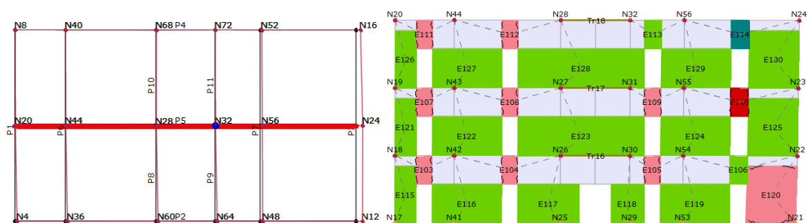
Slika 48. Mehanizam loma kritičnog zida u X smjeru (12. provjera, Model A; T/Č metoda – SNZ)
