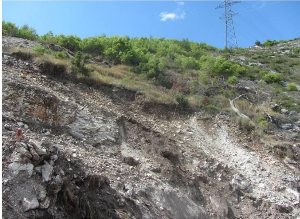
Slika 34. Blok u matriksu s veličinom bloka manjom od 30 cm – GP Brgat
