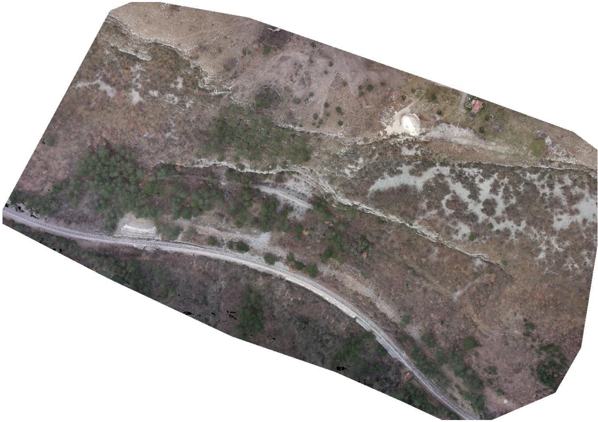
Slika 138. Digitalni ortofoto visoke rezolucije stijenskog pokosa na lokaciji Raspadalica snimljen SfM tehnikom iz bespilotne letjelice
