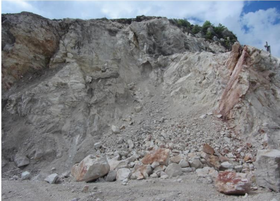
Slika 14. Primjer suhog pokosa ocijenjen s 3 boda
