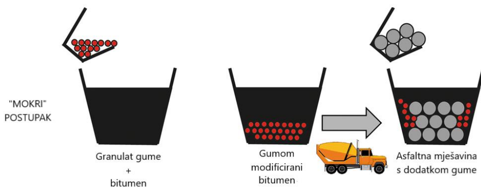
Slika 20: „Mokri“ postupak dodavanja granulata gume u bitumen [24]
