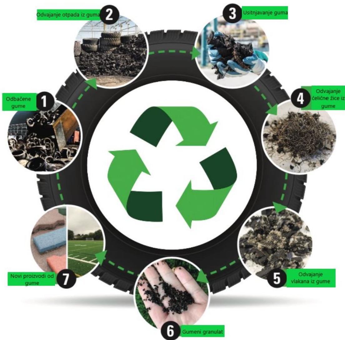
Slika 19: Postupak proizvodnje gumenog granulata iz otpadnih guma [24]
