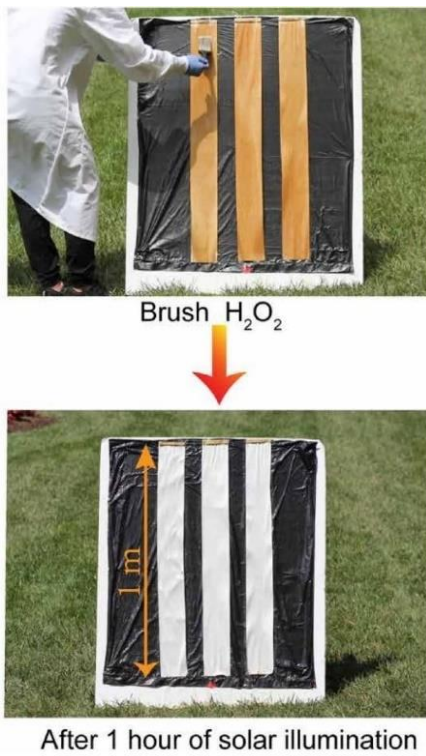
Slika 6: Prikaz premazivanja sloja vodikovog peroksida na neprozirno drvo izloženo jednosatnoj sunčevoj svjetlosti [1]
