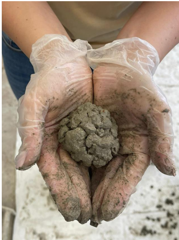
Slika 14 : Prikaz dlanovima formirane kuglice procjdnog betona (izvor: vlastita fotografija)
