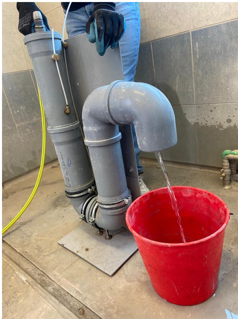
Slika 17 : Prikaz uređaja za ispitivanje koeficijenta propusnosti (izvor: vlastita fotografija)
