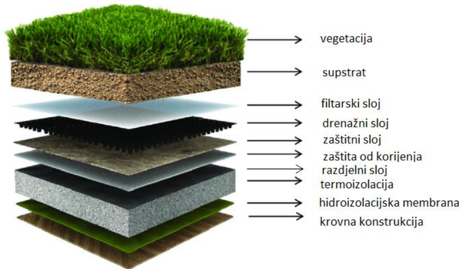
Slika 11: Slojevi ekstenzivnog zelenog krova
