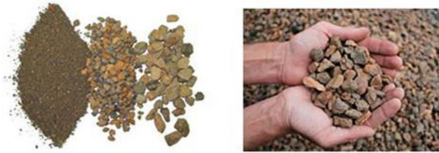
Slika 39, 40: Prirodni materijali drenažnog sloja
