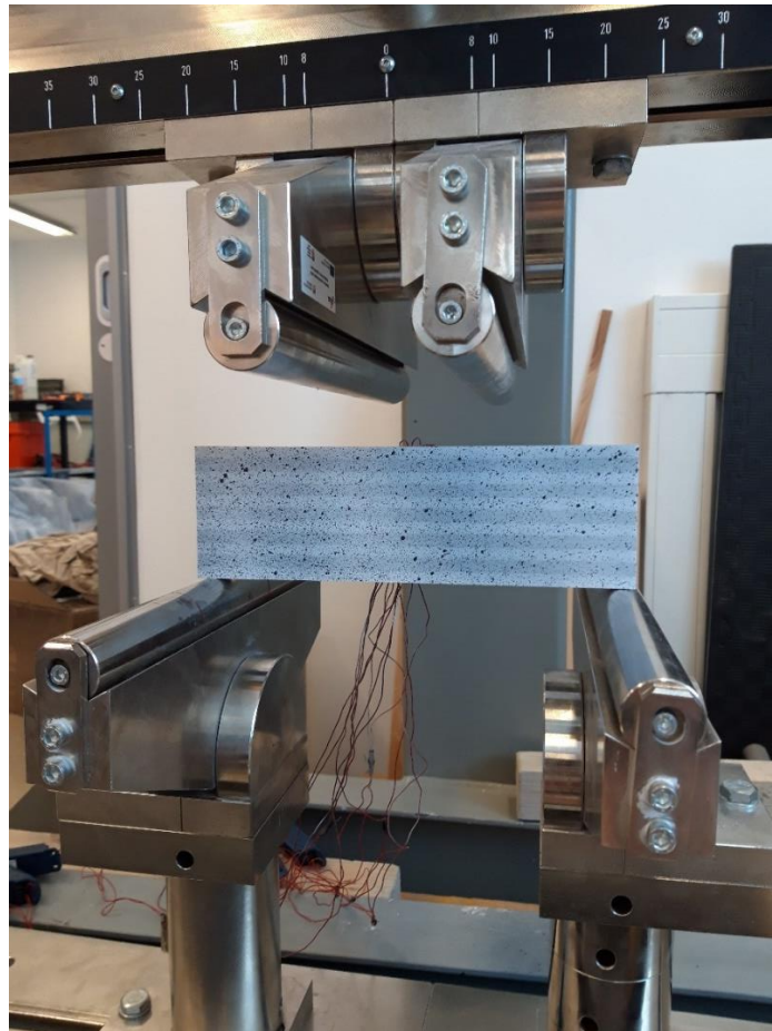
Slika 19: Spreman uzorak postavljen u prešu
