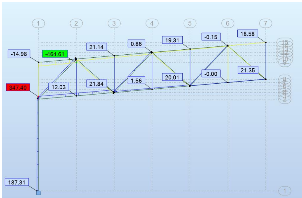
Slika 35: Dijagram uzdužnih sila u nosaču za pritiskajuće djelovanje
