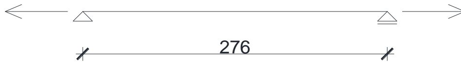
Slika 46: Vlačno opterećenje elementa
