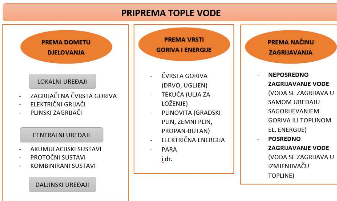
Slika 12: Podjela pripreme tople vode prema dometu djelovanja, vrsti goriva i energije te prema načinu zagrijavanja
