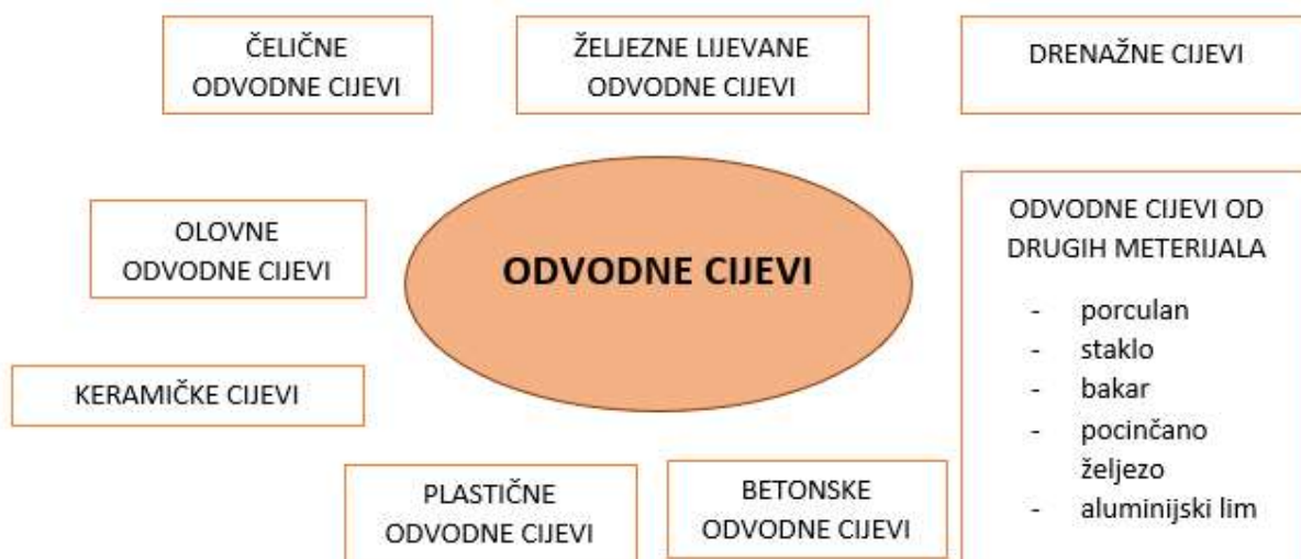
Slika 17: Podjela odvodnih cijevi
