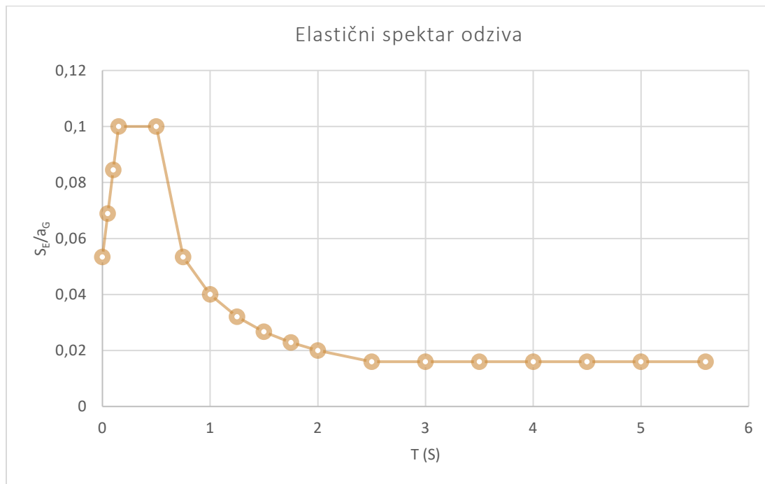
Slika 68. Elastični spektar odziva (Izrađeno u Excel-u)
