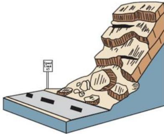
Slika 1. Shematski prikaz odronjavanja stijenske mase [3]
