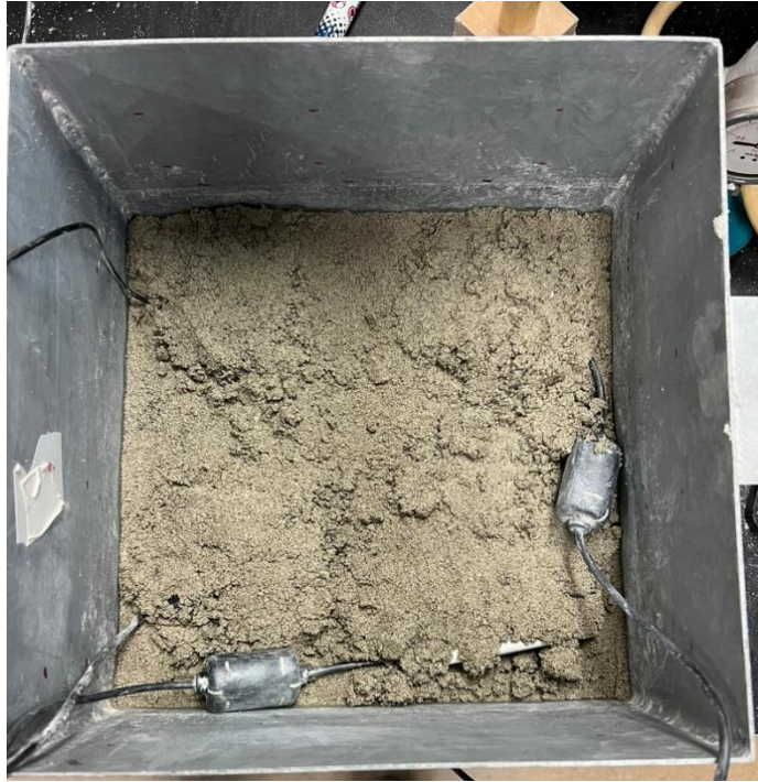
Slika 19. Prikaz ugrađenih senzora unutar Posude 4 na visini od h=5 cm
