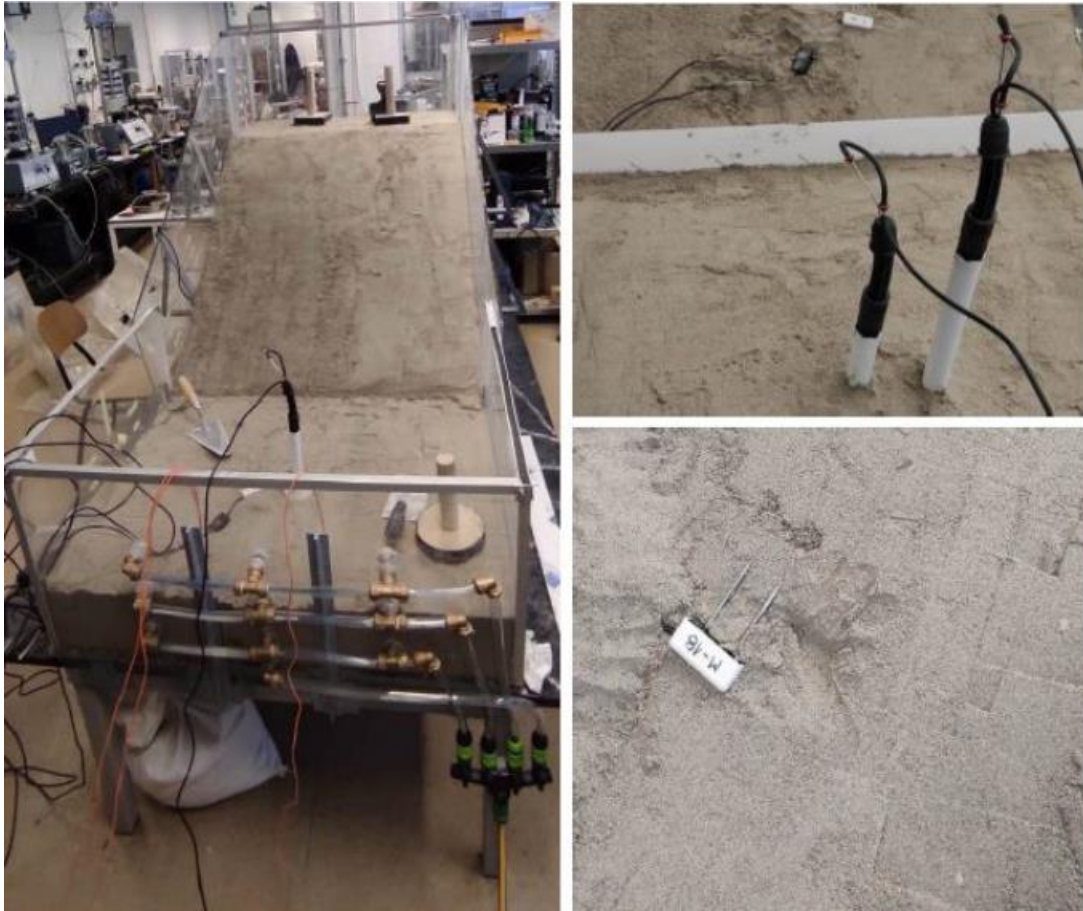
Slika 56. Prikaz umanjenog fizikalnog modela prilikom ugradnje senzora
