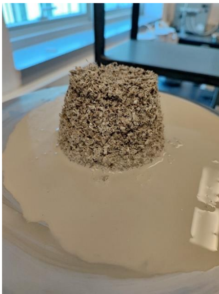
Slika 33. Primjer segregacije dobivene korištenjem samo superplastifikatora
