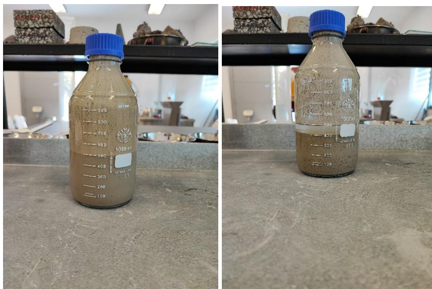
Slika 39. Ispitivanje udjela pora svježeg morta prije (lijevo) i nakon (desno) taloženja
