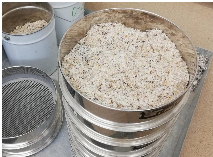
Slika 21. Prekomjerna količina materijala na jednom situ tokom postupka prosijavanja uzorka PVC piljevine
