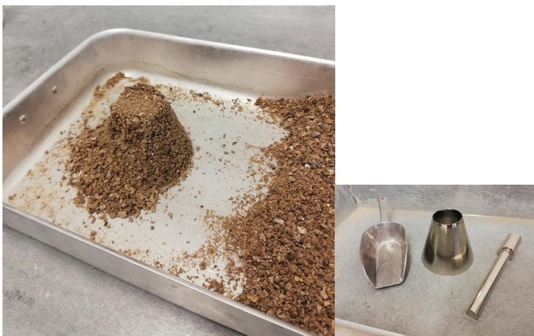
Slika 12. Zasićen i površinski suh pijesak – uzorak je djelomično osipan
