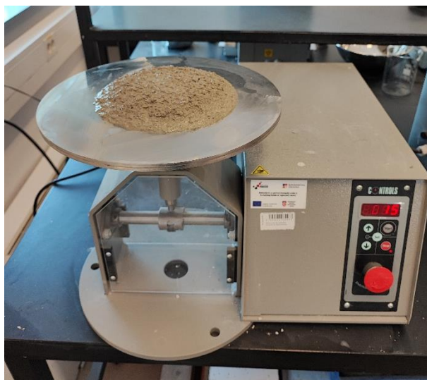
Slika 32. Ispitivanje konzistencije metodom rasprostiranja optimalne mješavine CM-PVC5
