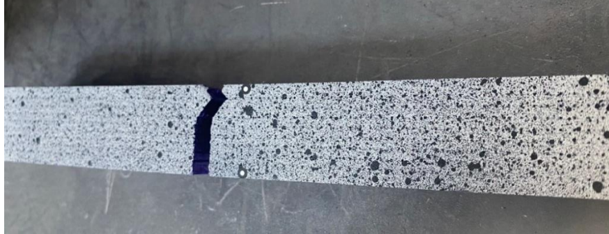
Slika 44: Slomljeni uzorak nakon ispitivanja.
