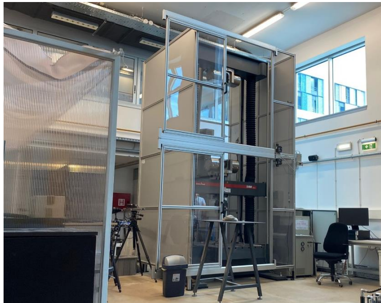
Slika 25: Kidalica Zwick/Roell Z600 u laboratoriju za konstrukcije Građevinskog fakulteta u Rijeci.
