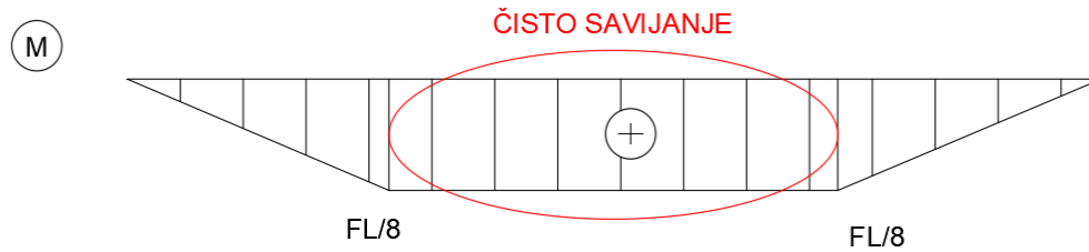
Slika 14: Područje čistog savijanja za zadanu gredu.
