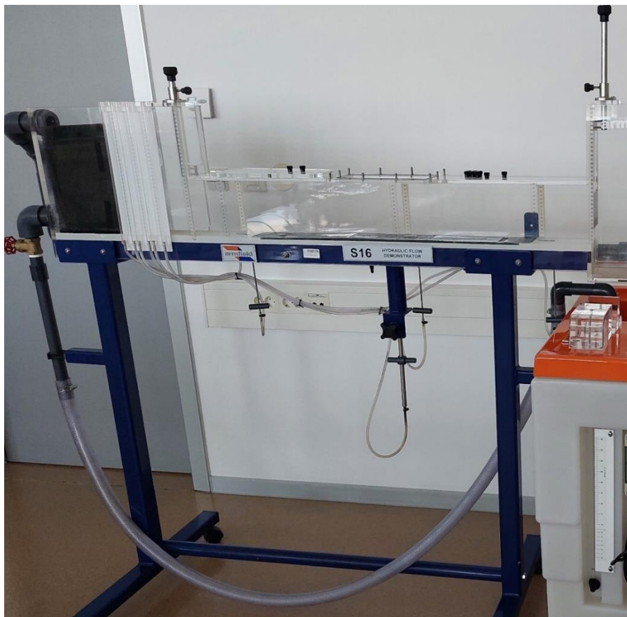
Slika 33. Mali hidraulički žlijeb na metalnom postolju
