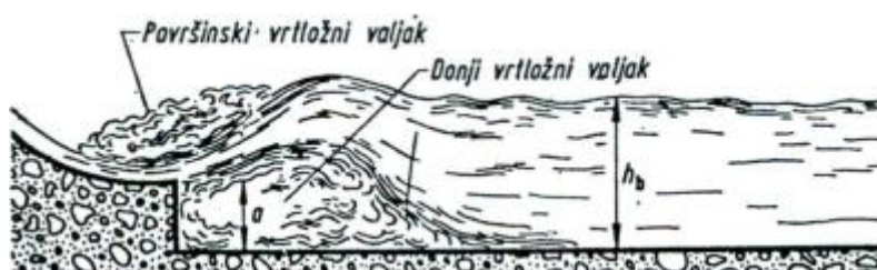
Slika 28. Spajanje vodnih razina u obliku potopljenog površinskog skoka (Agroskin, 1969.)
