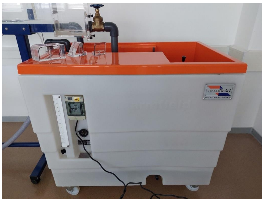
Slika 32. Spremnik vode za recirkulaciju vode u sustavu hidrauličkog žlijeba
