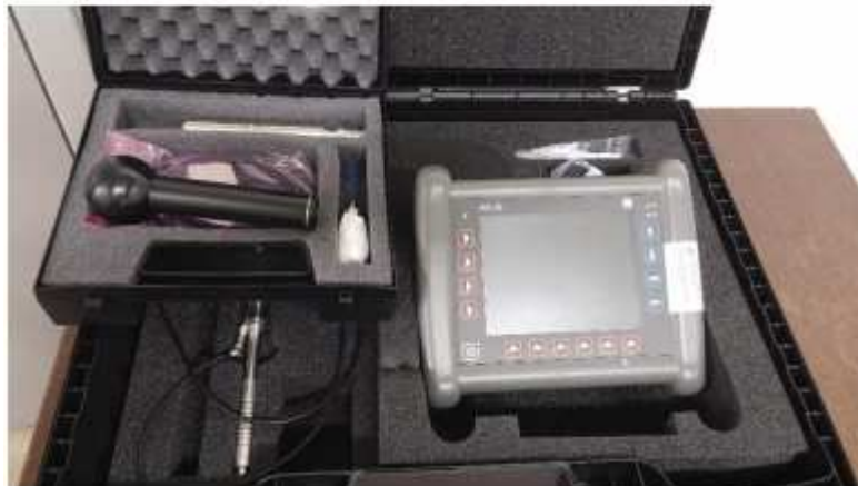
Slika 8: Prikaz osnovne opreme uređaja Krautkramer MIC 20 [10]
