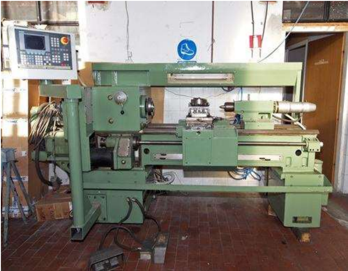
Slika 40.: Tokarilica T-200 NCR s numeričkim upravljanjem [25]
