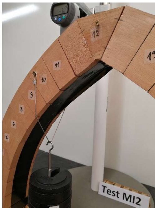
Slika 80. Model M: odljepljivanje pojačanja između blokova 11 i 12
