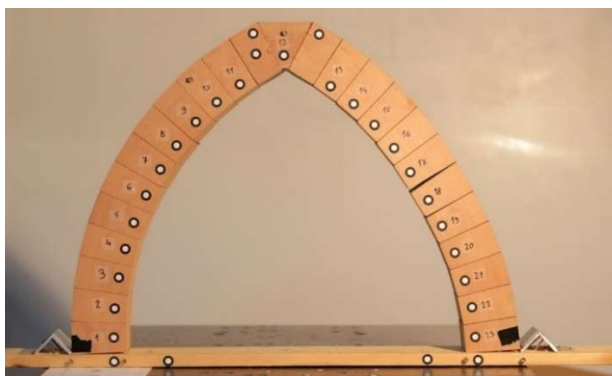
Slika 92. Otvaranje zglobova na modelu ME1P
