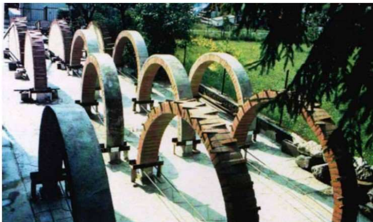
Slika 37. Modeli za ispitivanje [7]
