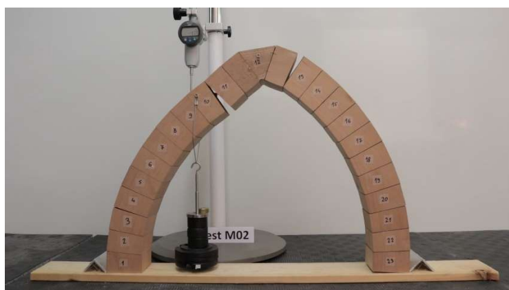
Slika 60. Model M02 – mehanizam sloma
