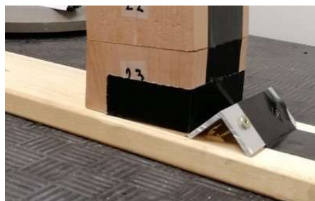
Slika 69. Detalj sidrenja pojačanja na osloncu
