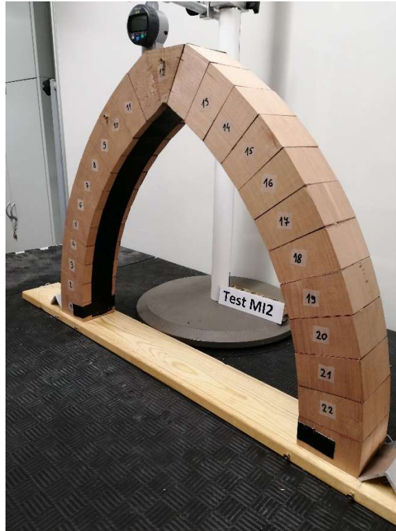
Slika 78. Model M s pojačanjem na intradosu
