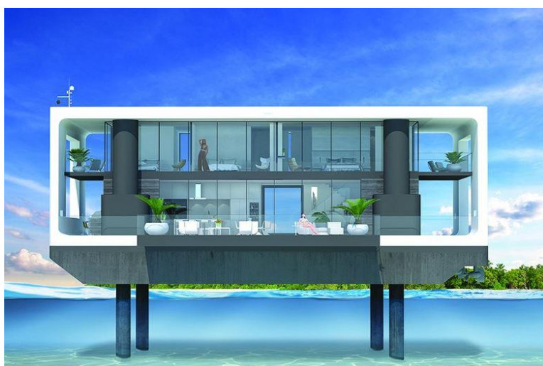
Slika 2: Arkup 75 s spušenim hidrauličkim stupovima, off-grid (izvor: https://robbreport.com/motors/marine/arkup-glass-yacht )
