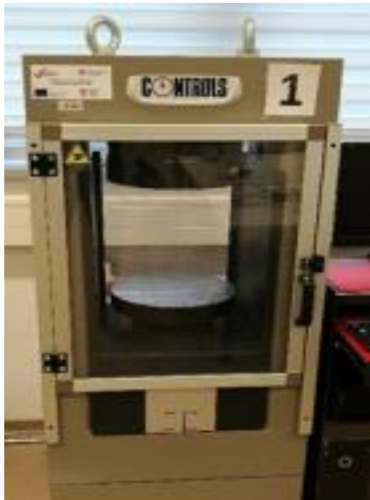
Slika 57. Preša za ispitivanje tlačne čvrstoće, Građevinski fakultet, Rijeka
