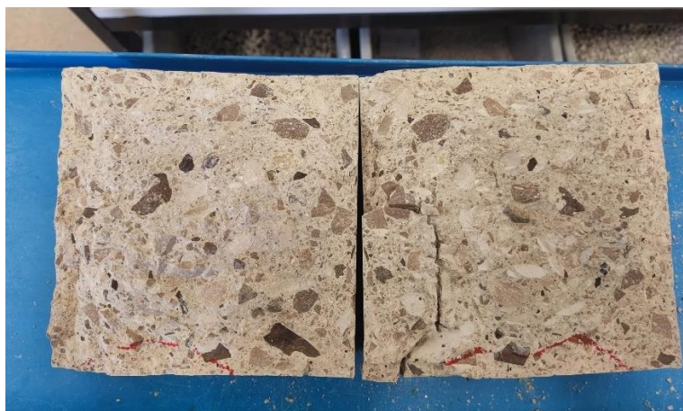
Slika 65. Uzorak mješavine 1 nakon cijepanja
