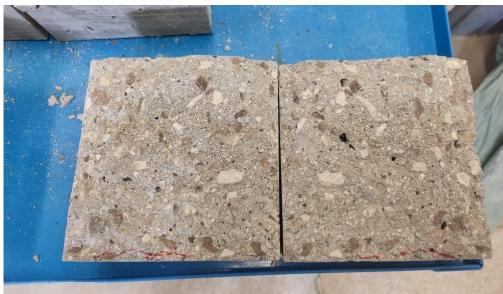
Slika 67. Uzorak mješavine 3 nakon cijepanja
