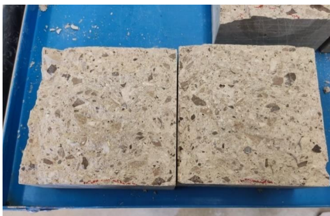
Slika 66. Uzorak mješavine 2 nakon cijepanja
