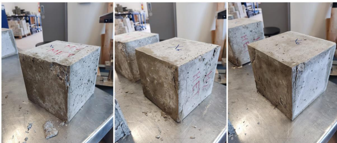
Slika 59. Betonski uzorci mješavine 2 nakon ispitivanja tlačne čvrstoće
