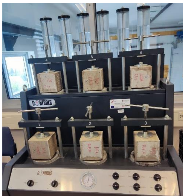
Slika 64. Uzorci izloženi hidrostatskom tlaku 72 sata
