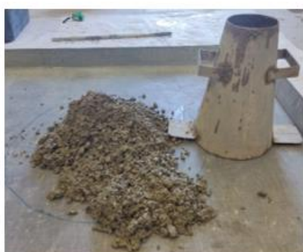
c) nepravilno slijeganje, nedostatak vode
