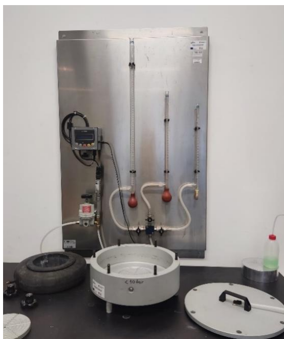
Slika 34. Uređaj za ispitivanje plinopropusnosti betona u laboratoriju za materijale, Građevinski fakultet u Rijeci
