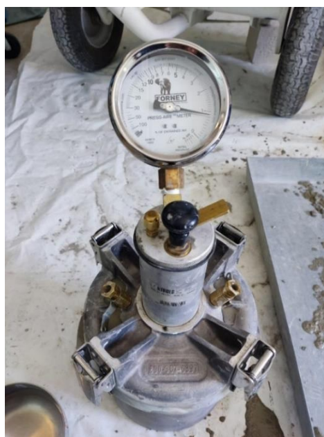
Slika 52. Porometar iz laboratorija za materijale Građevinskog fakulteta u Rijeci
