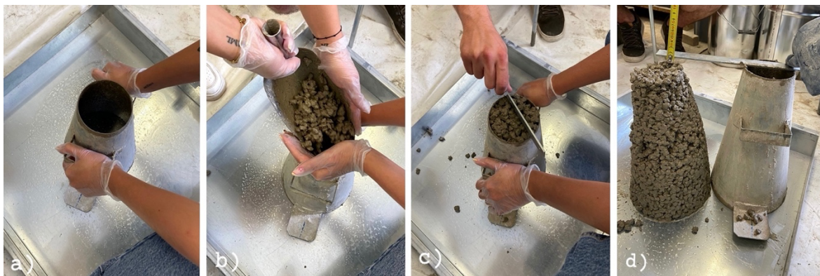
Slika 24: a) Abrahamsov konus na ravnoj podlozi, b) Punjenje smjesom u 3 sloja, c) Poravnavanje gornje površine ravnjačom, d) Mjerenje slijeganja, (izvor: vlastite fotografije)
