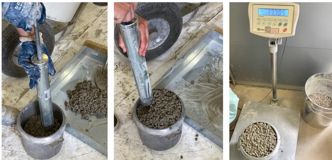
Slika 23: Postupak ispitivanja sadržaja šupljina (izvor: vlastite fotografije)
