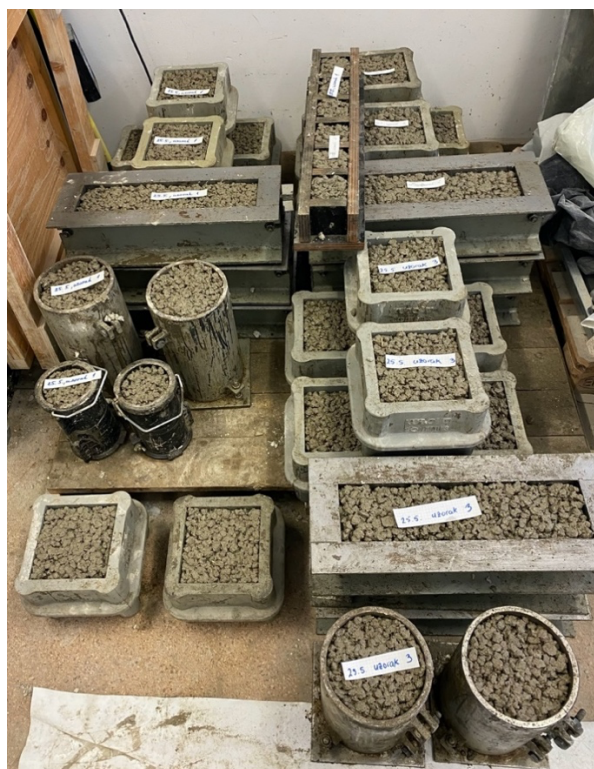
Slika 22: Beton ugrađen u kalupe (izvor: vlastita fotografija)
