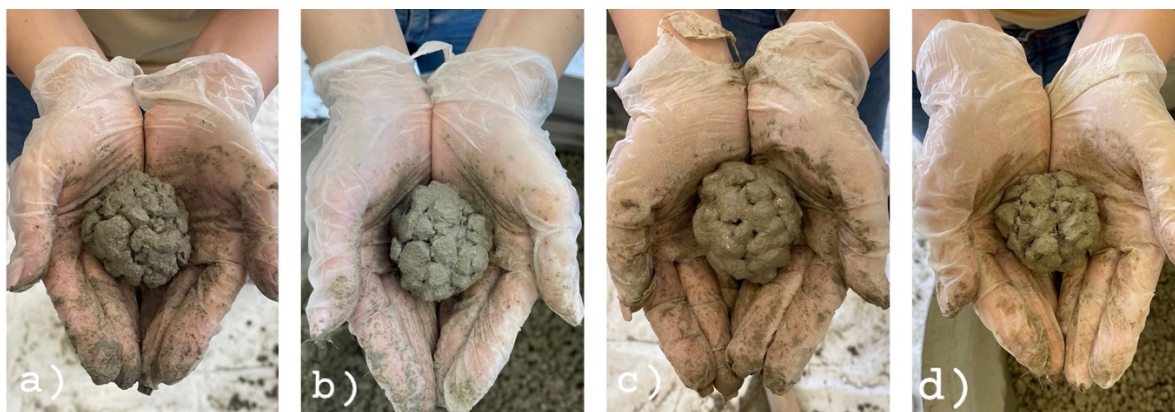
Slika 25: a) Ispitivanje konzistencije mješavine 1 metodom kuglice, b) Ispitivanje konzistencije mješavine 2 metodom kuglice, c) Ispitivanje konzistencije mješavine 3 metodom kuglice, d) Ispitivanje konzistencije mješavine 4 metodom kuglice (izvor: vlastite fotografije)
