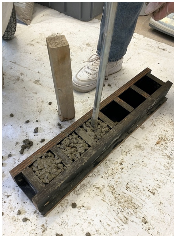
Slika 21: Ugradnja betona u kalupe (izvor: vlastita fotografija)
