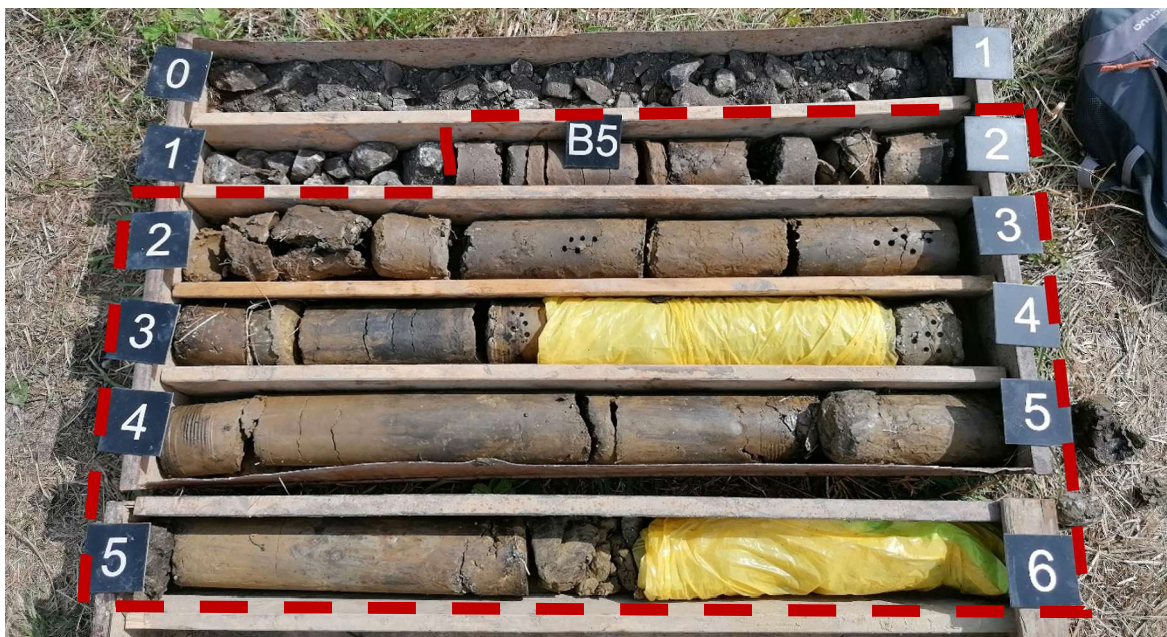
Slika 19. Naslage geotehničke jedinice 2 - Gline u sklopu bušotine B-5 (Geotech d.o.o.)
