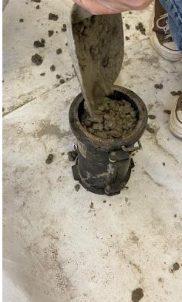
Slika 19: Ugradnja procjedinog betona u kalup (izvor: vlastita fotografija)
