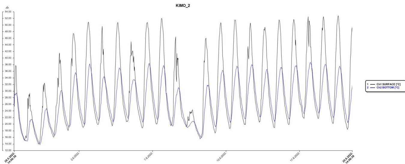
Slika 28: Graf promjene temperature za uzorak od procjednog betona (izvor: vlastita fotografija)
