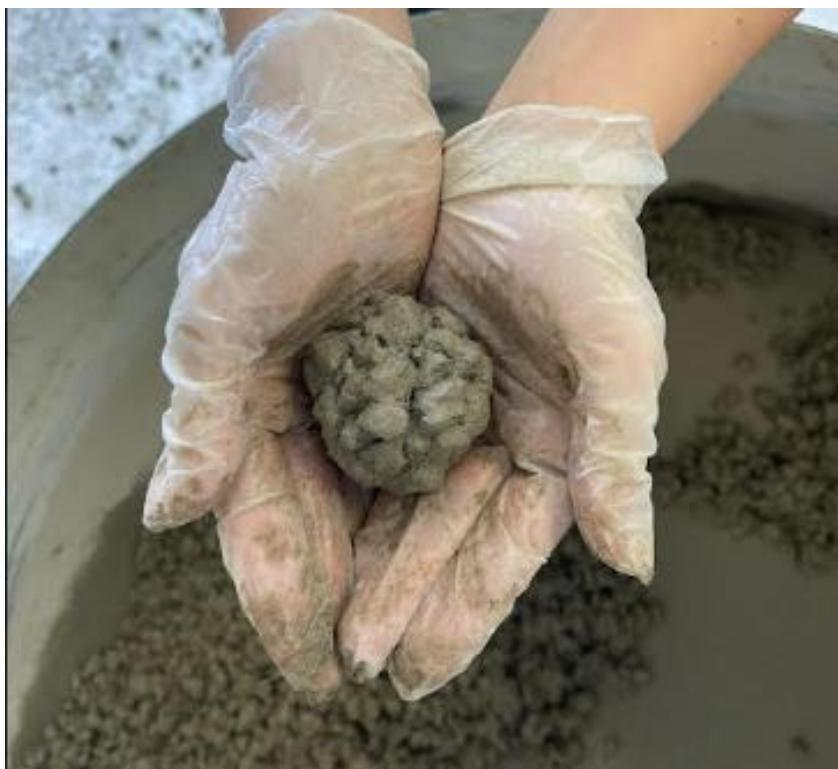
Slika 8: Ispitivanje konzistencije metodom kuglice (izvor: vlastita fotografija)
