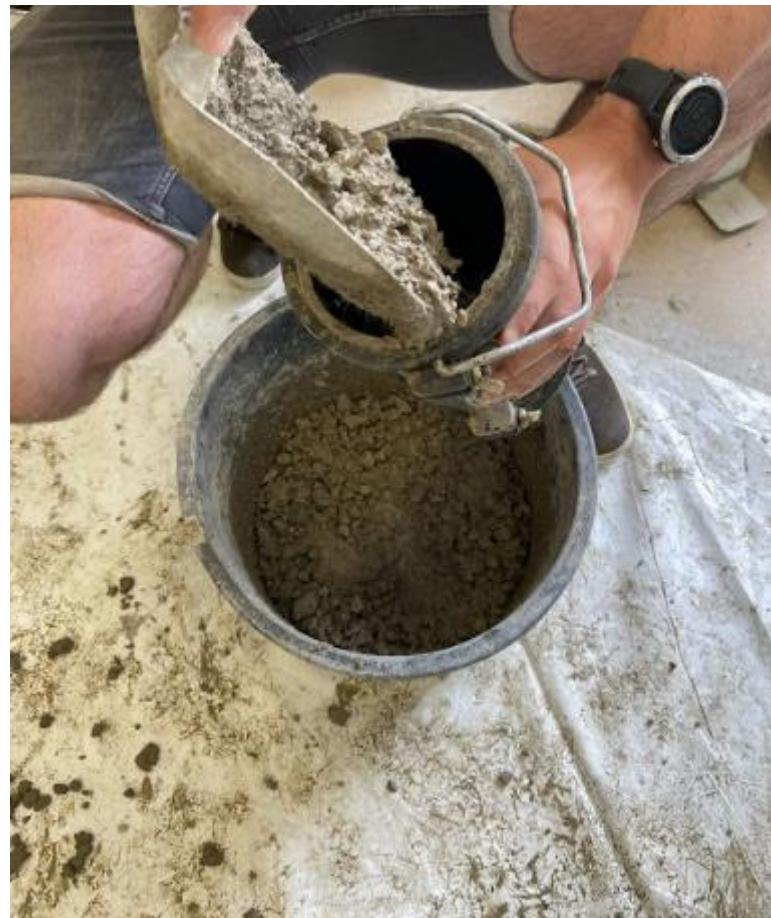
Slika 21: Ugradnja običnog betona u kalup oblika valjka dimenzija  $\varnothing 100 \times 200$  mm (izvor: vlastita fotografija)
