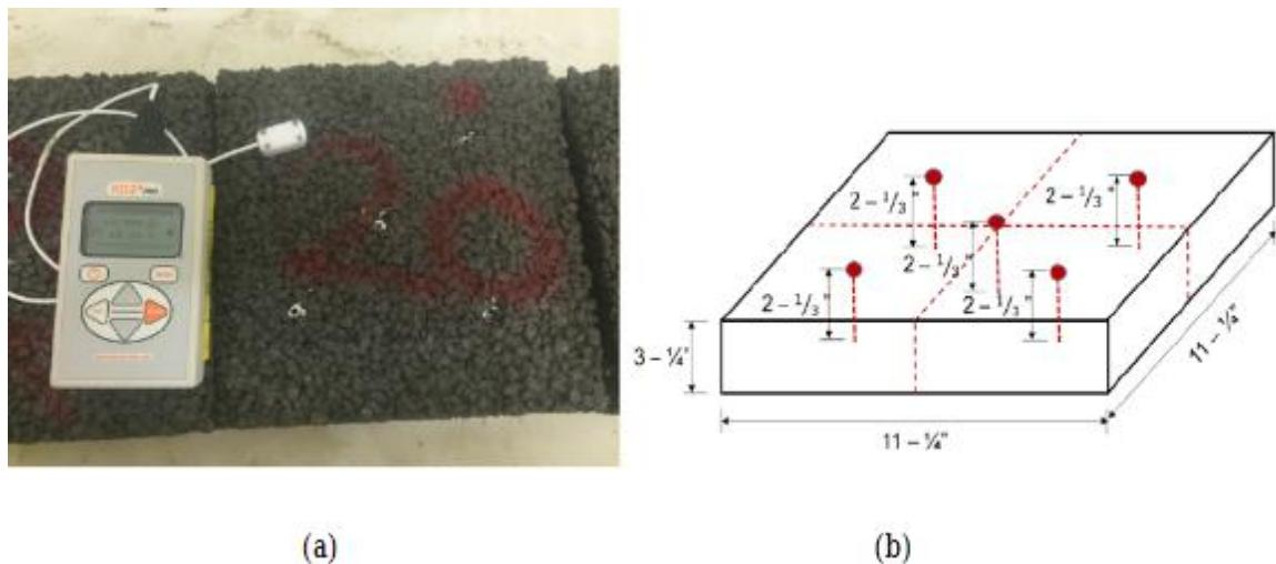
Slika 10: a) Mjerenje toplinske provodljivosti mokre betonske ploče termalnom igličastom sondom,
