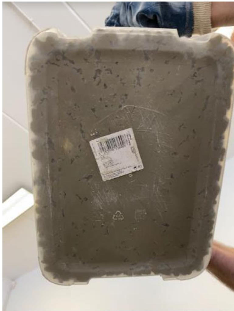
Slika 20: Izgled vibriranog uzorka procjednog betona (izvor: vlastita fotografija)
