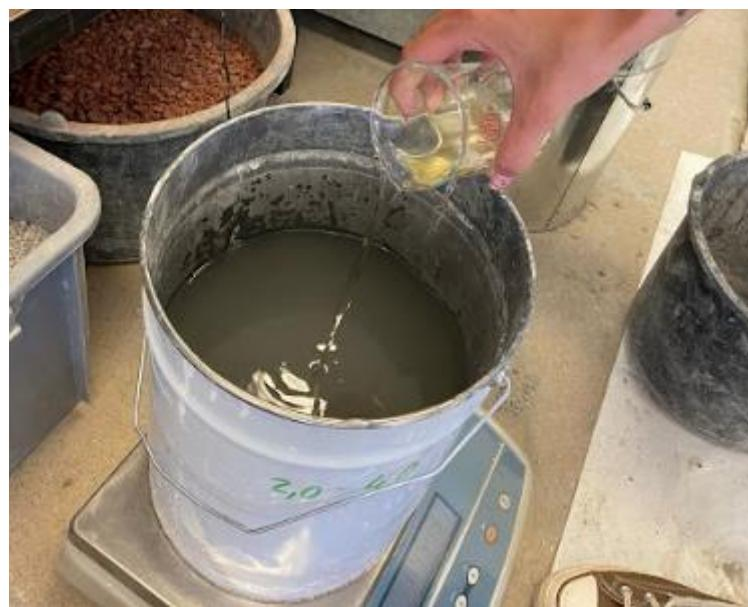
Slika 18: Dodavanje superplastifikatora u vodu (izvor: vlastita fotografija)
