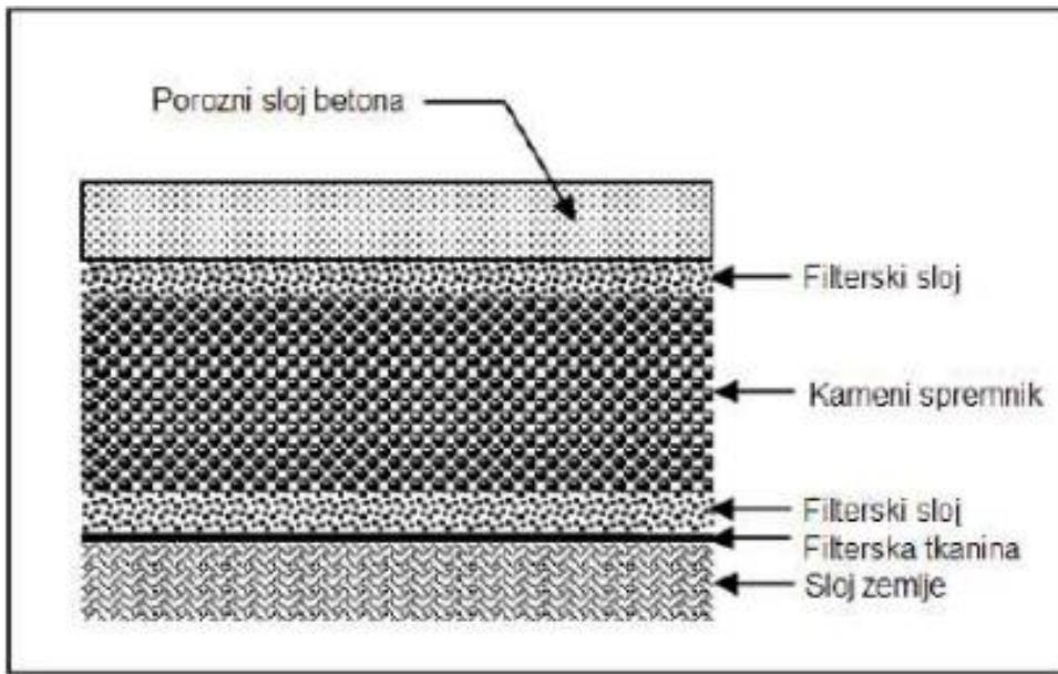
Slika 4: Poprečni presjek procjednog betona [3]
