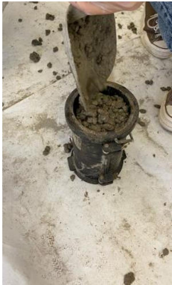
Slika 19: Ugradnja procjednog betona u kalup (izvor: vlastita fotografija)
