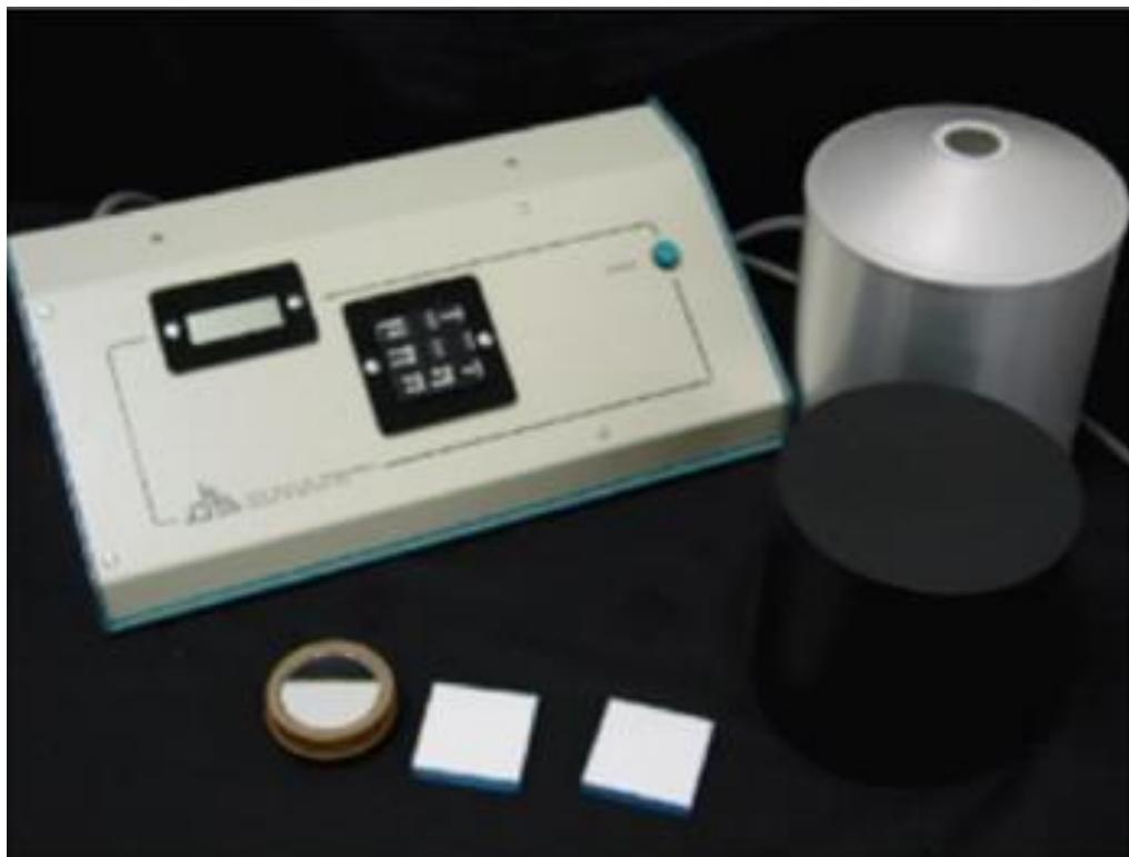
Slika 12: Reflektometar solarnog spektra [12]
