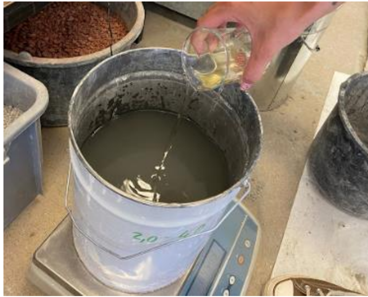
Slika 18: Dodavanje superplastifikatora u vodu (izvor: vlastita fotografija)
