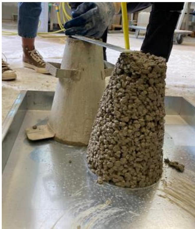
Slika 23: Mjerenje konzistencije slijeganjem (izvor: vlastita fotografija)
