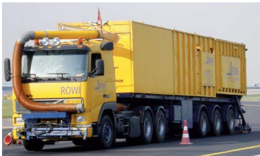
Slika 39. Stroj za visokotlačni pritisak vodenim mlazom [24]
