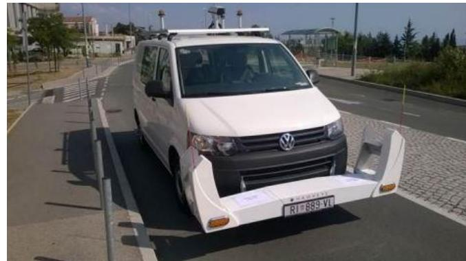
Slika 35. Mjerno vozilo opremljeno laserskim profilometrom [25]
