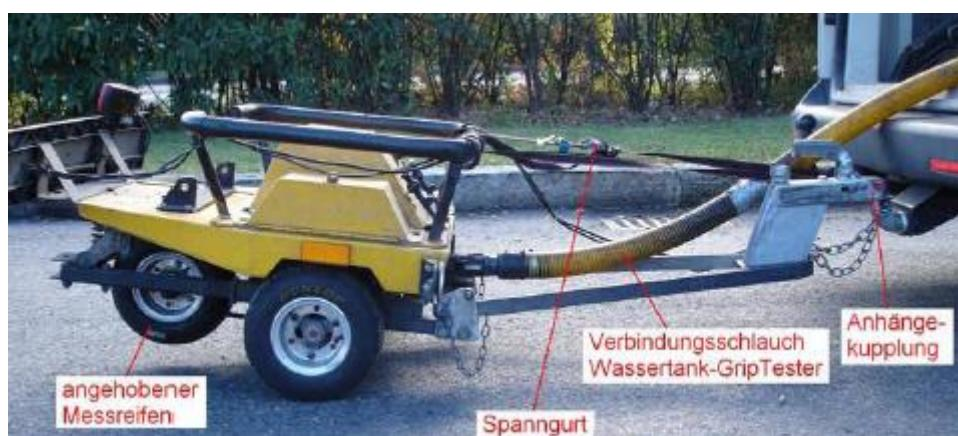
Slika 32. Dinamički uređaj – skidometar [23]
