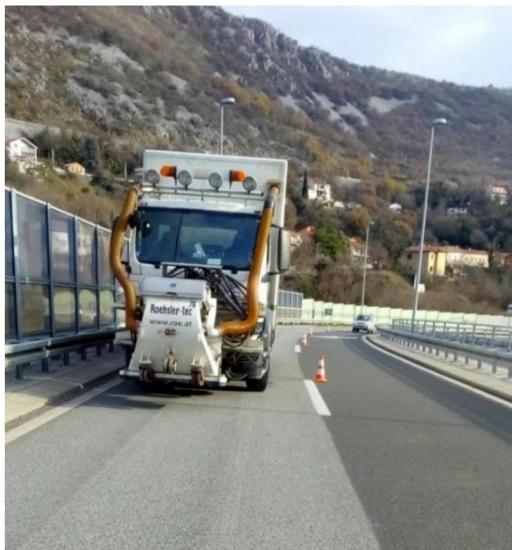
Slika 38. Primjer stroja za povećanje hvaljivosti
