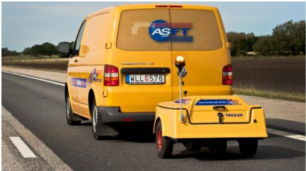
Slika 42. Surface friction trailer [28]
