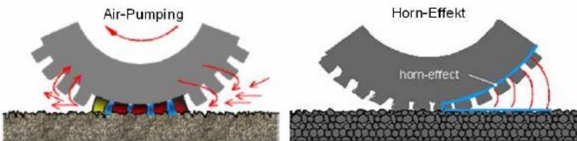
Slika 27. Dodir pneumatika kotača vozila i podloge [23]
