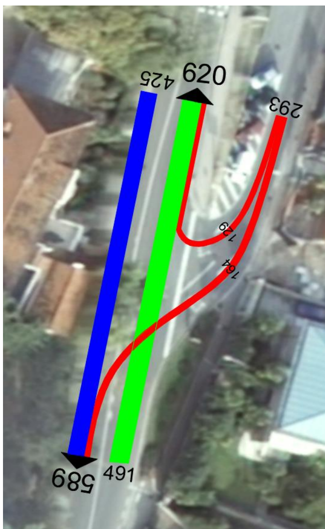
Slika 33: Prikaz grafičkog opterećenja u vršnom satu na raskrižju Punta Kolova
